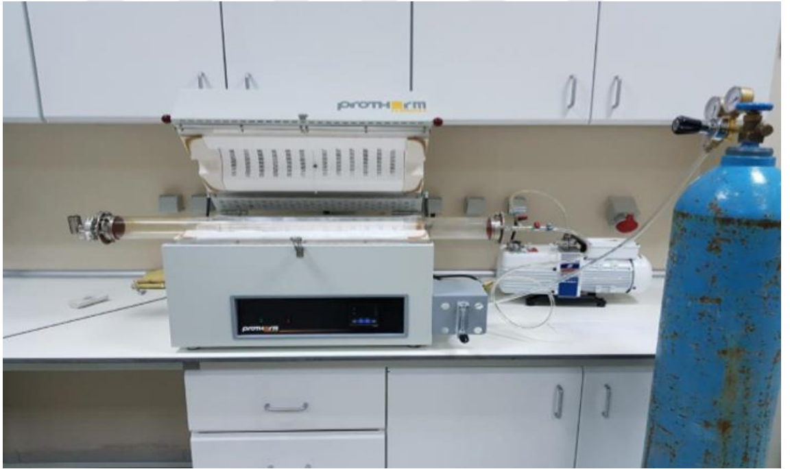
Şekil 3.4. Vakum ve gaz kontrollü ısıtılma işlem fırını
