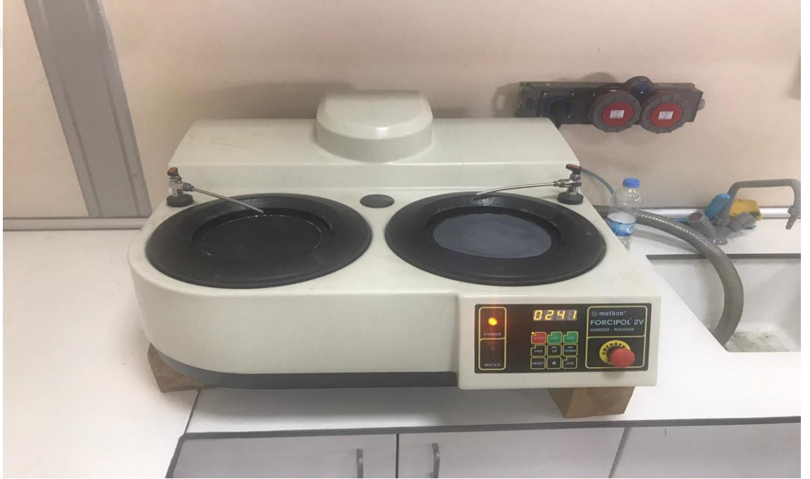
Şekil 3.2. Zımparalama ve Parlatma Cihazı
