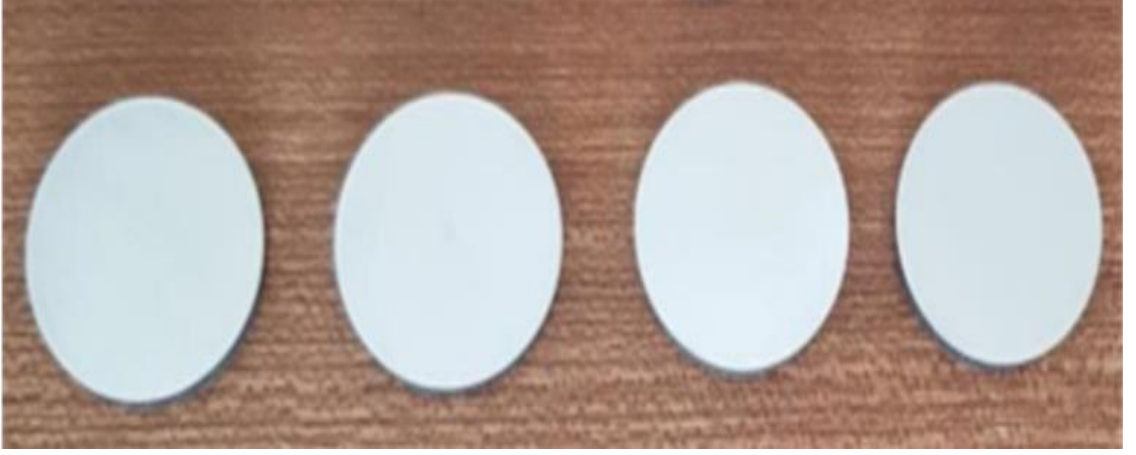
Şekil 3.1. Parlatma işlemi yapılmış taban malzeme örnekleri
