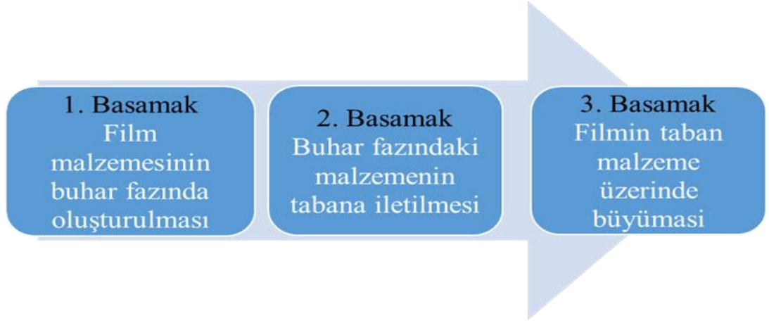
Şekil 2.9. Fiziksel buhar fazında kaplama prosesi
