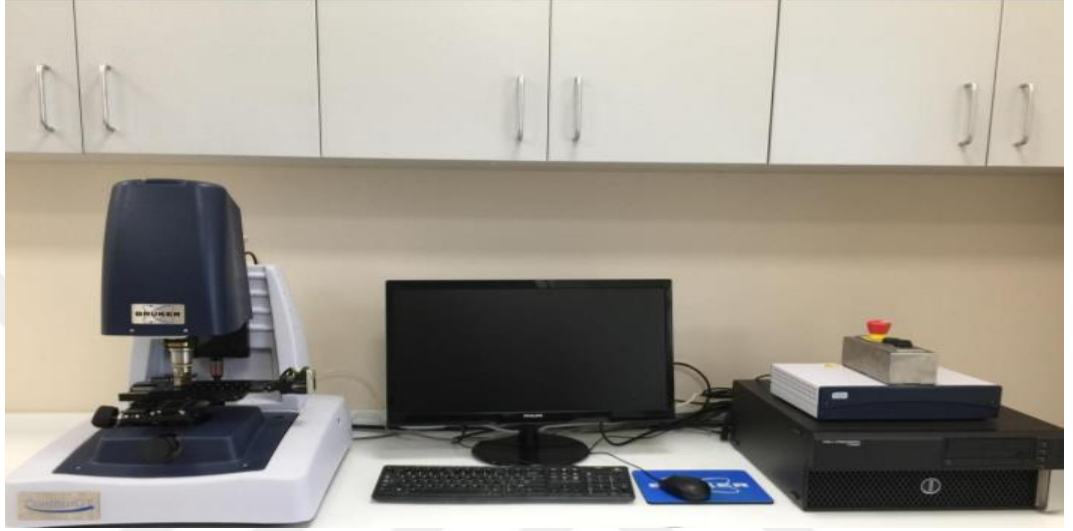
Şekil 3.11. 3D yüzey profilometre analizlerinin yapıldığı cihazın görüntüsü
