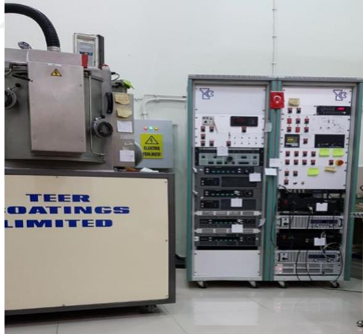
Şekil 3.3. Kapalı alan dengesiz manyetik alanda sıçratma sistemi (CFUBMS)
