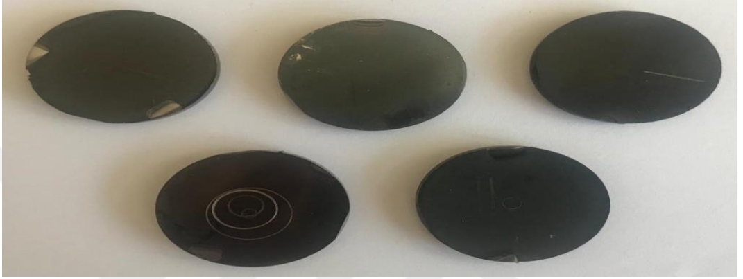
Şekil 4.1. AISI D2 taban malzemeler üzerine büyütülmüş MoS 2 filmler
