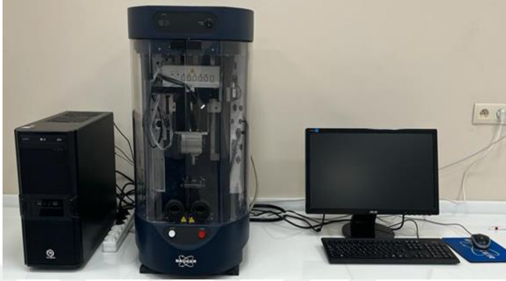
Şekil 3.9. Bruker-UMT aşınma test cihazı
