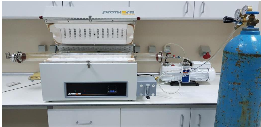
Şekil 3.7. Atmosfer kontrollü ısıtılma fırını
