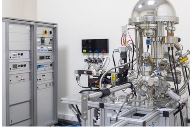
Şekil 3.6. Specs-Flex XPS cihazı
