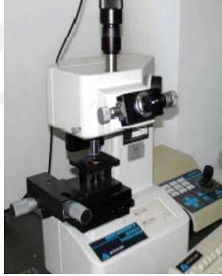
Şekil 3.8. Mikro sertlik cihazı (Buehler Micromet 2001)
