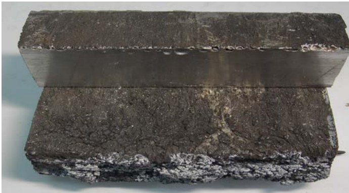
Resim 5.2. AZ91 ön alaşım (ocak atmosferi: argon, kalıp: atmosferik ortam)
