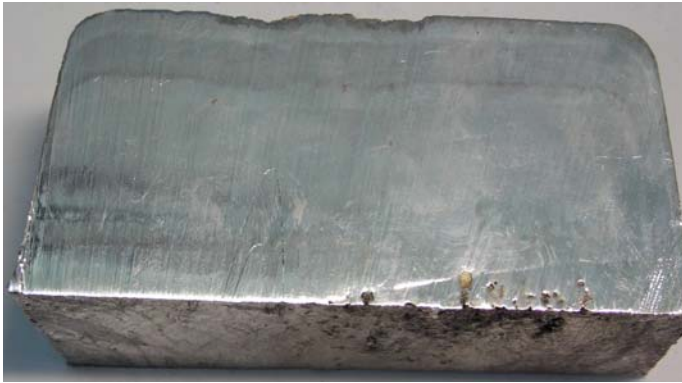
Resim 5.4. AZ91 ön alaşım (ocak atmosferi: argon, kalıp atmosferi: \text{CO}_2 + \%0,8 \text{ SF}_6 )
