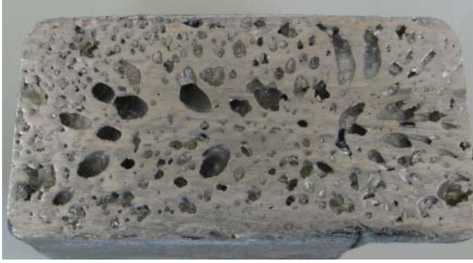
Resim 5.1. AZ91 ön alaşım (ocak ve kalıp atmosferi: \text{CO}_2 + \%0,8 \text{ SF}_6 )
