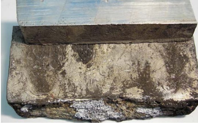
Resim 5.3. AZ91 ön alaşım (ocak atmosferi: Argon, kalıp atmosferi: argon)
