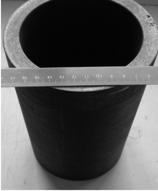
Resim 4.1. Ergitme işleminde kullanılan grafit pota resmi
