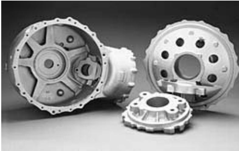
Resim 2.4. WE43 alaşımından dökülmüş helikopter vites kutusu [15, 23]
