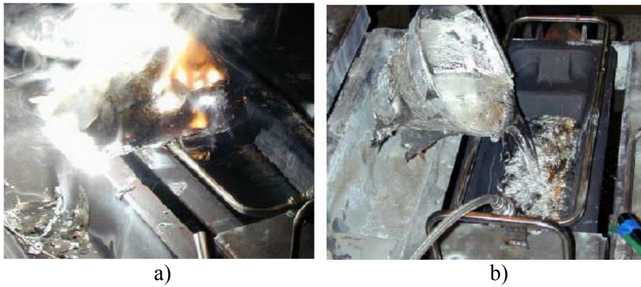
Resim 3.2. Mg alaşımı dökümlerinde gaz kullanımı a) atmosfer ortamı b) SF 6 [45]
