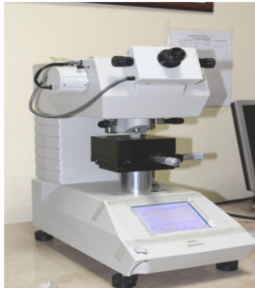
Şekil 5.9. HMV model SHIMADZU marka dijital sertlik cihazı.
