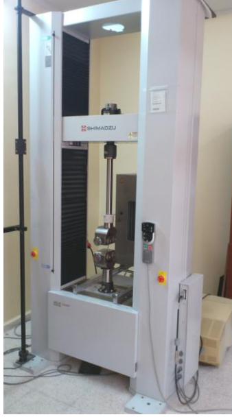
Şekil 5.8. SHIMADZU Autograph AG-IC 100 kN marka çekme cihazı.
