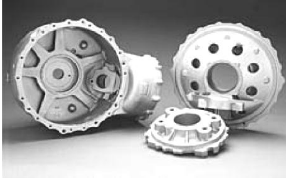
Şekil 2.7. WE43 alaşımından dökülmüş helikopter vites kutusu (Žaludová, 2005).
