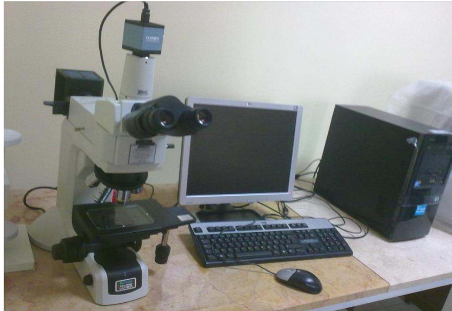
řekil 5.5. NİKON Eclipse LV150 marka optik mikroskop.
