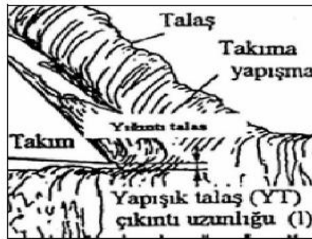
Şekil 3.8. Sıvanmalı sürekli talaş (Aydın, 2002).
