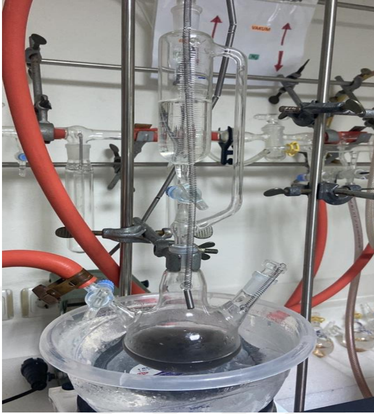
Şekil 3.3. Metil magnezyum iyodürün oluşumu
