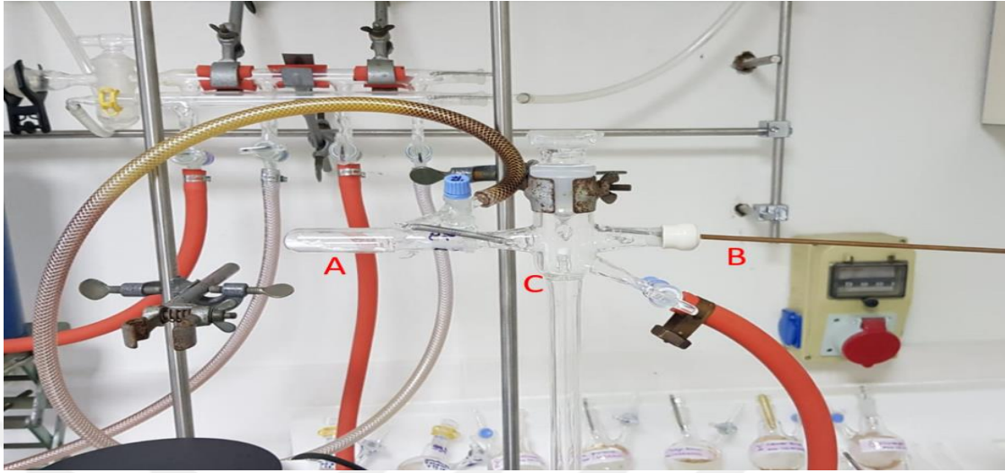
Şekil 4.4. [Me_6Mg_7(OR)_8] , ( R = Et, ^nPr, ^nBu ) bileşiklerinden azot gazı ( N_2 ) altında termogravimetrik analiz (TGA) için numune alma işlemi
