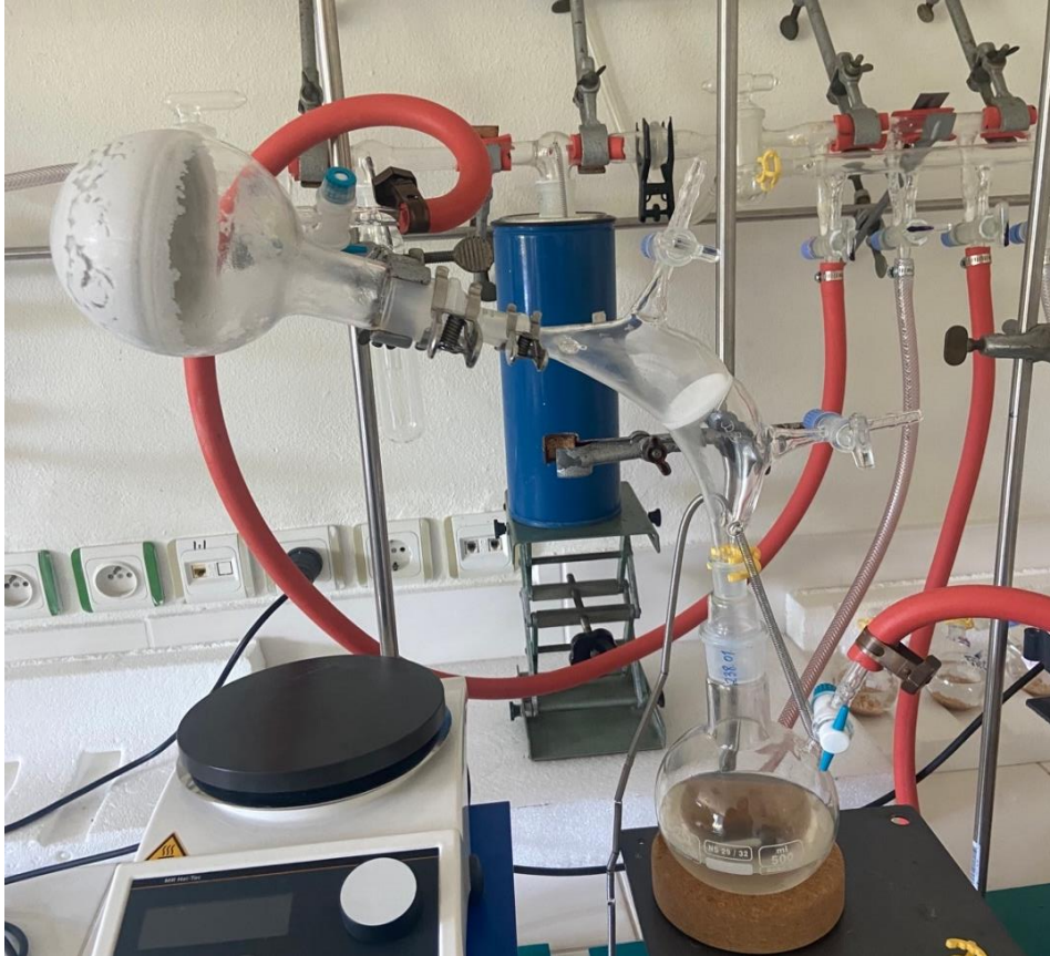
Şekil 3.6. Dimetil magnezyum ve magnezyum iyodür süzme işlemi
