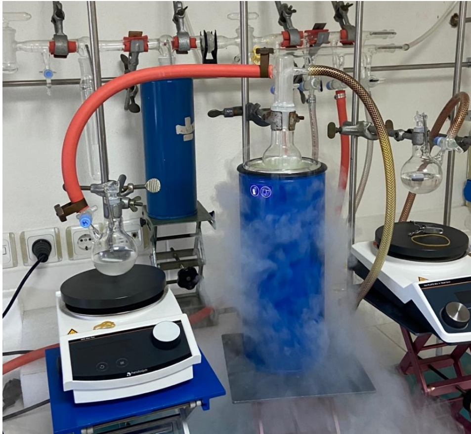
Şekil 3.7. Dimetil magnezyum vakum ile kurutma işlemi
