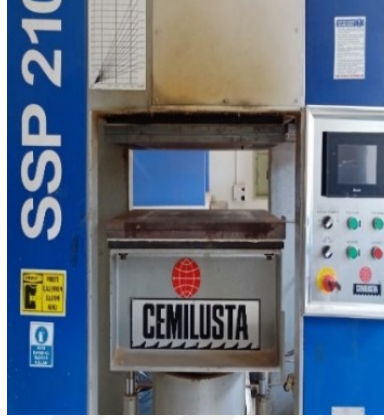
Şekil 1. Tek katlı sıcak pres
