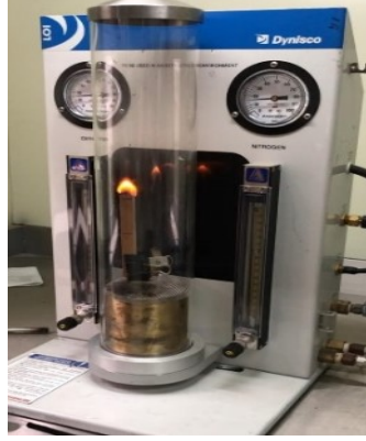
Şekil 3. LOI Cihazı (Dynisco)
