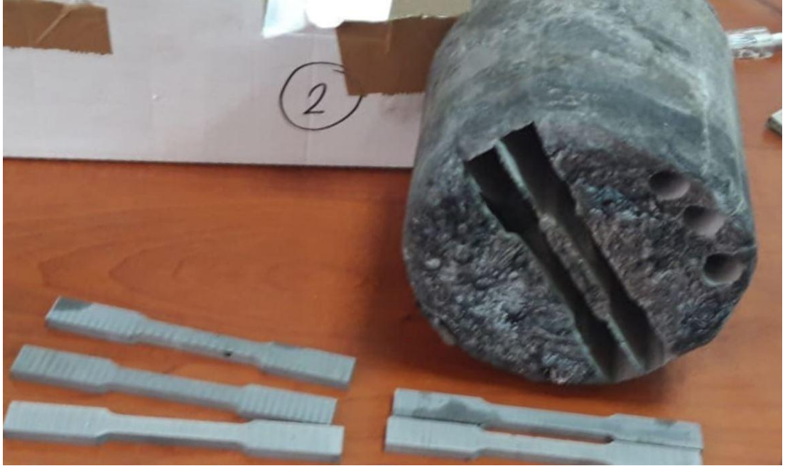
Şekil 4.18. Tel erozyon cihazında işlenmiş, zımparalama işlemi öncesi çekme deneyi numunelerinin görüntüsü.
