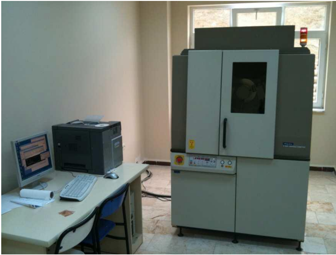
Şekil 4.9. Rigaku D-Max 1000 X-ışını cihazı.
