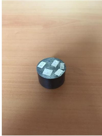
Şekil 4.11. Metalografik inceleme için hazırlanmış numune örnekleri.
