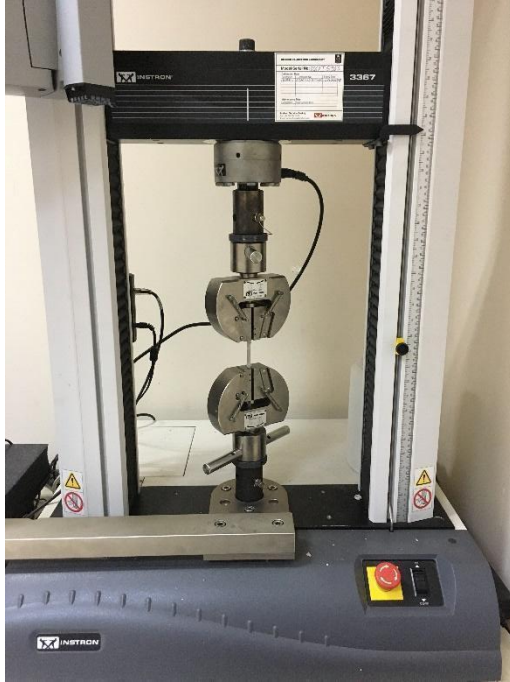
Şekil 4.20. Çekme deneylerinin yapıldığı Instron 3367 marka çekme cihazı.
