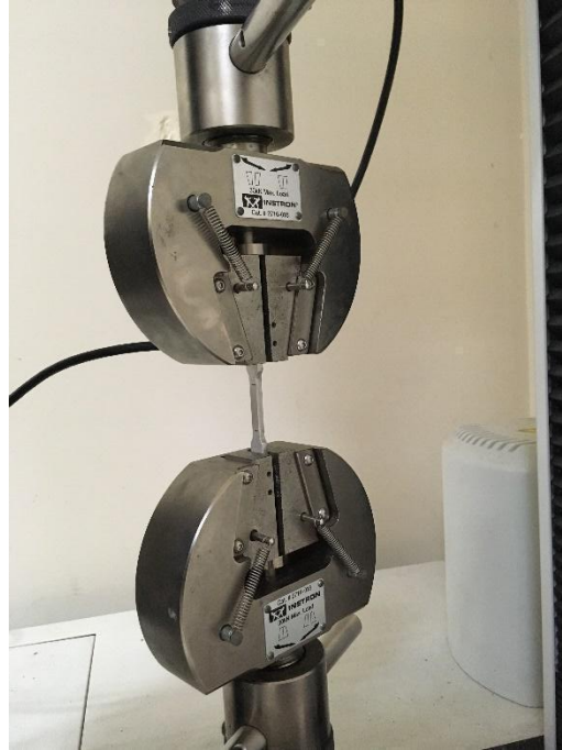
Şekil 4.20. Çekme deneylerinin yapıldığı Instron 3367 marka çekme cihazı.
