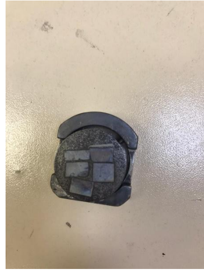
Şekil 4.11. Metalografik inceleme için hazırlanmış numune örnekleri.
