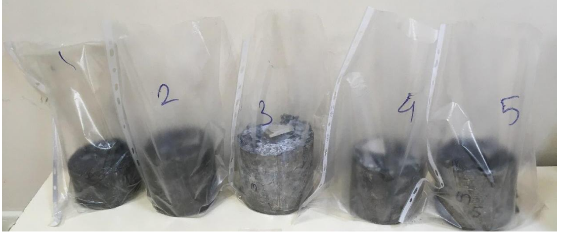
Şekil 4.7. Döküm işlemi sonrası kalıptan çıkarılan Mg-8Li-2Al, Mg-8Li-2Al-1,5Sn, Mg-8Li-2Al-1,5La, Mg-8Li-2Al-1,5Nd ve Mg-8Li-2Al-1,5Ca alaşımları.
