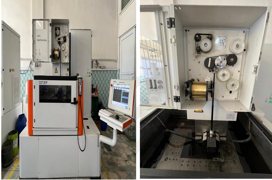
Şekil 4.15. GF marka tel erozyon işleme cihazı
