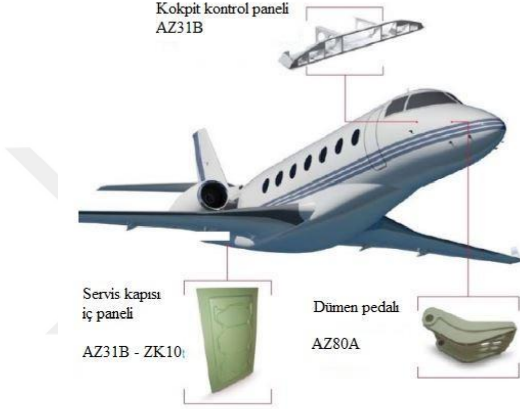
Şekil 3.13. Uçak endüstrisindeki magnezyum alaşımları için uygulamalar (Dziubińska ve ark., 2016).
