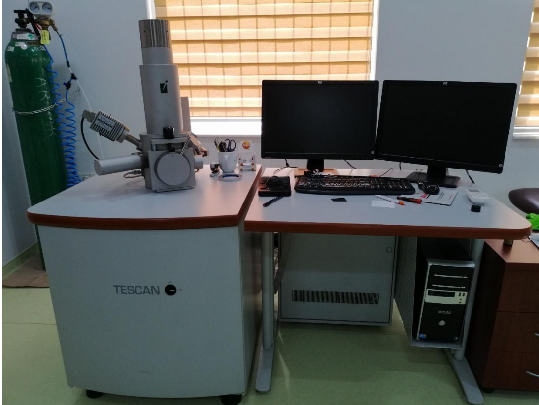
Şekil 4.13. Tescan VEGA-II Elektron Mikroskobu.
