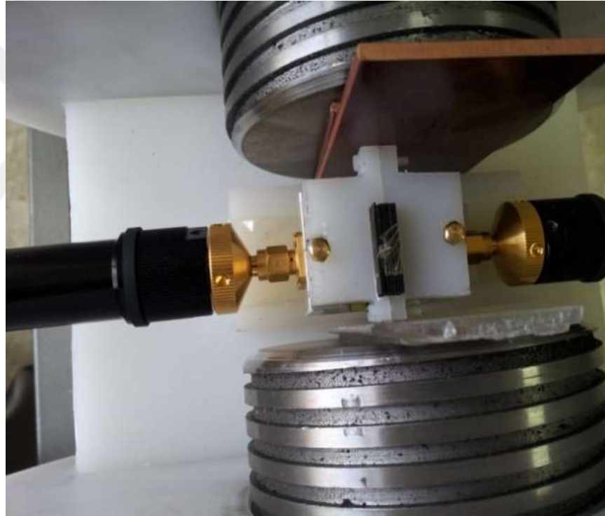
Şekil 4.29. Mıknatıs dizini kullanılarak elde edilen magnonik kristalin ölçüm sistemine yerleştirilmesi.
