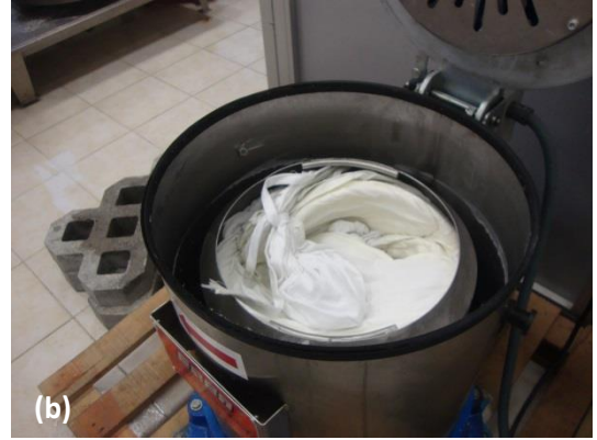
Şekil 3.8. a) Yoğurtların kendi halinde süzülmesi b) ön süzme yapılmış yoğurtların makinede süzülmesi
