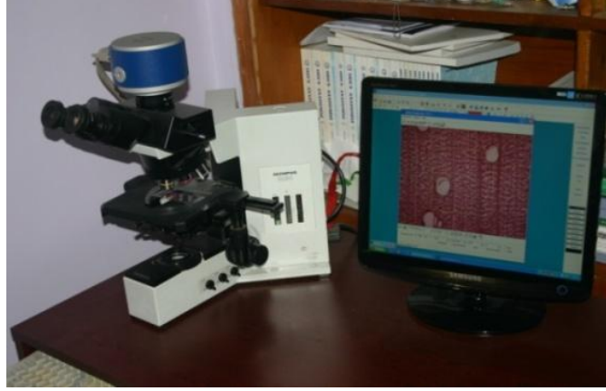
Şekil 2. Olympus B×50 Araştırma Mikroskobu ve BAP Bs200 Pro Image Analiz Sistemi
