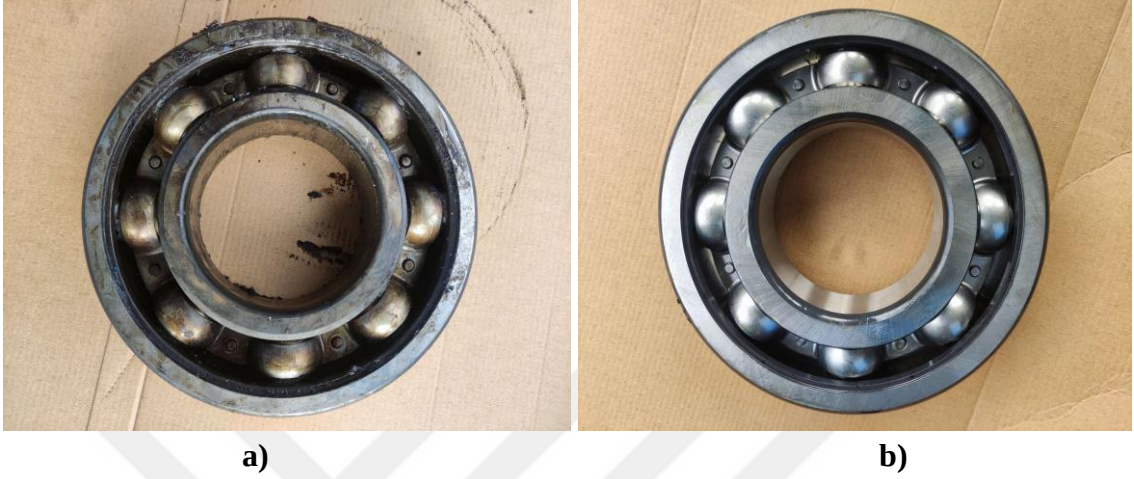
Şekil 1.9. Bismil Terfi İstasyonu A3 nolu pompa rulmanı a) Arızalı ve b) Sağlam
