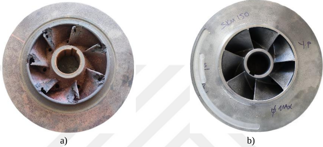
Şekil 1.7. Yatay milli santrifüj pompa fanı a) arızalı ve b) sağlam (Bismil Terfi Merkezi 5 nolu pompa)
