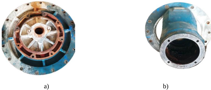
Şekil 1.3. Tek kademeli pompa a) gövde kapağı ve b) rulman yatağı (Silvan Terfi Merkezi 1 nolu pompa)
