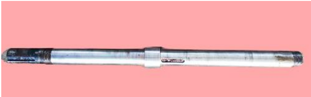
Şekil 1.6. kademeli pompa mili (Bismil Terfi Merkezi 5 nolu pompa)
