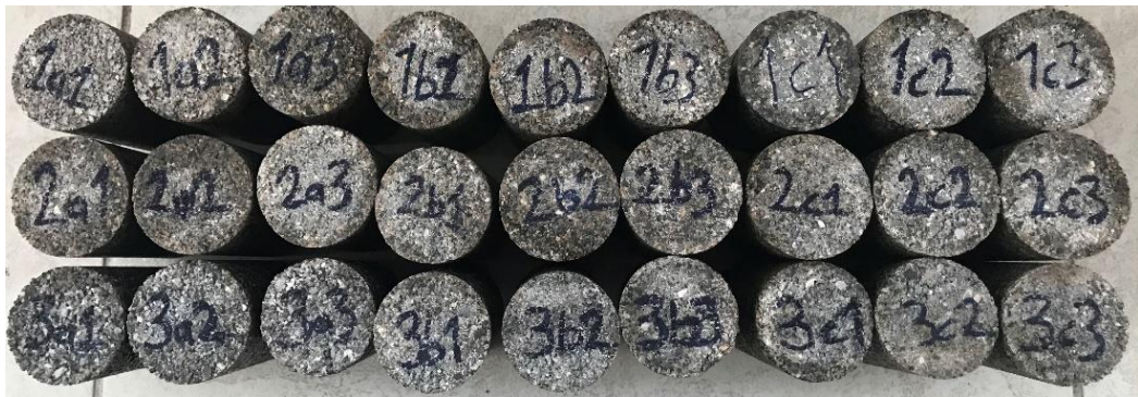
Şekil 3.17. Basma testi numuneleri.
