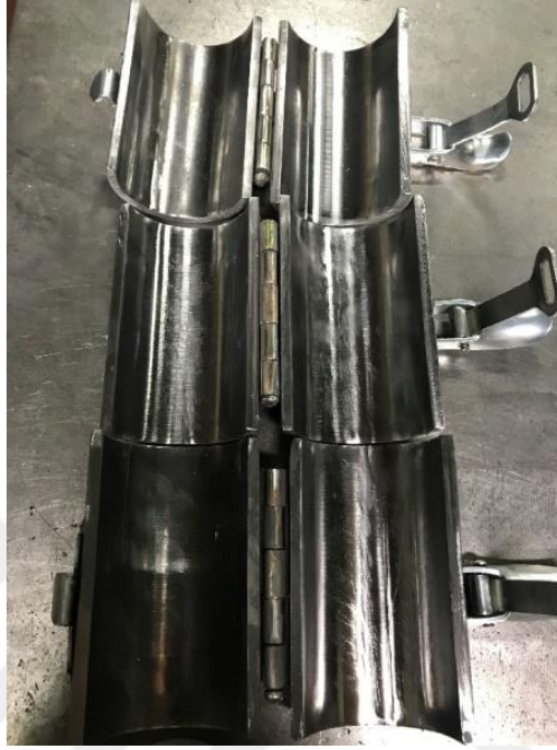
Şekil 3.8. Taşlama sonrası kalıplar.
