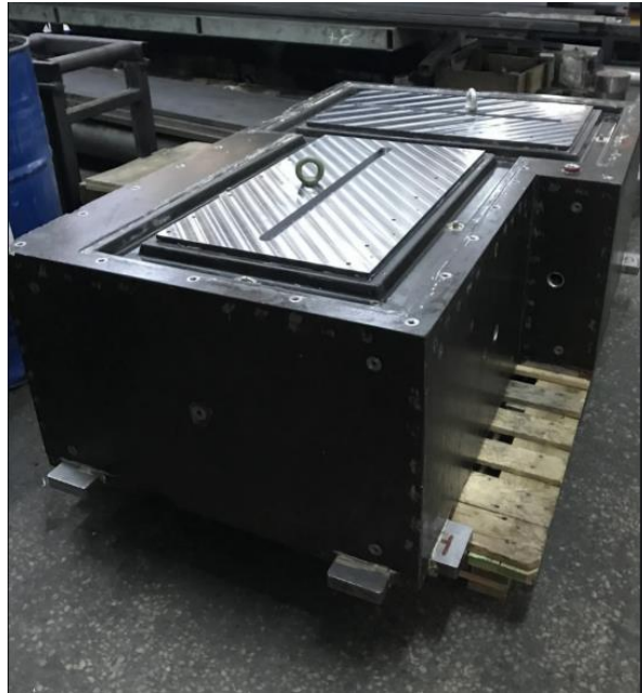
Şekil 2.1. Mineral döküm tezgah şasesi
