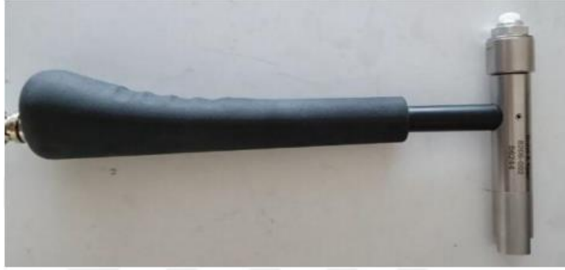
Şekil 3.12. Brüel&Kjaer Type 8206-002 model darbe çekici.
