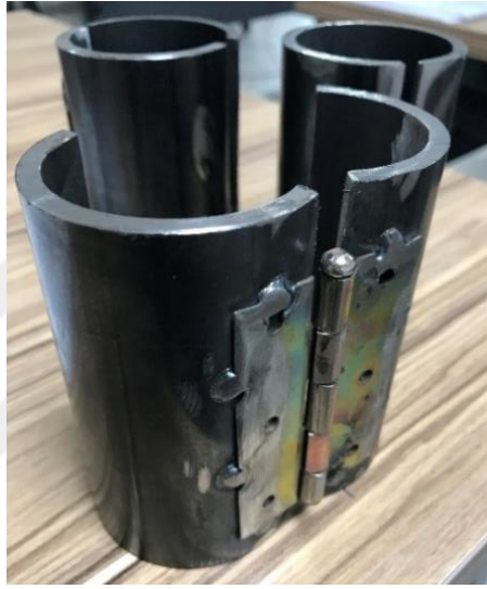
Şekil 3.4. Bir yüzeyine menteşe takılmış kalıplar.
