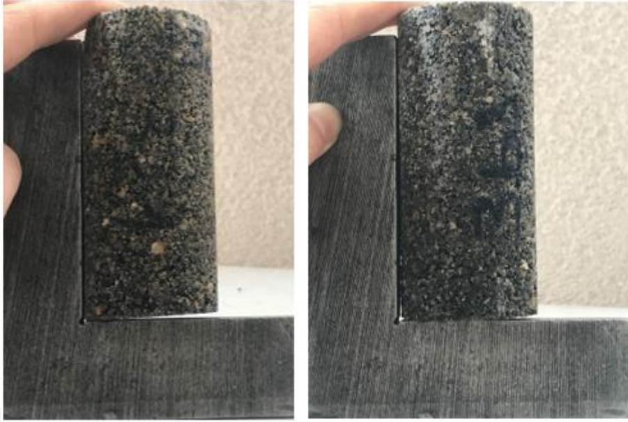
Şekil 3.18. Sınır yüzeyleri paralel olmayan 3c1 ve 3b3 numunesi.
