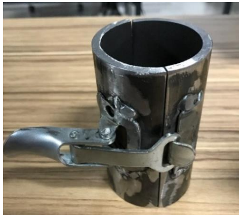
Şekil 3.5. Çanta kilidi takılmış kalıp.
