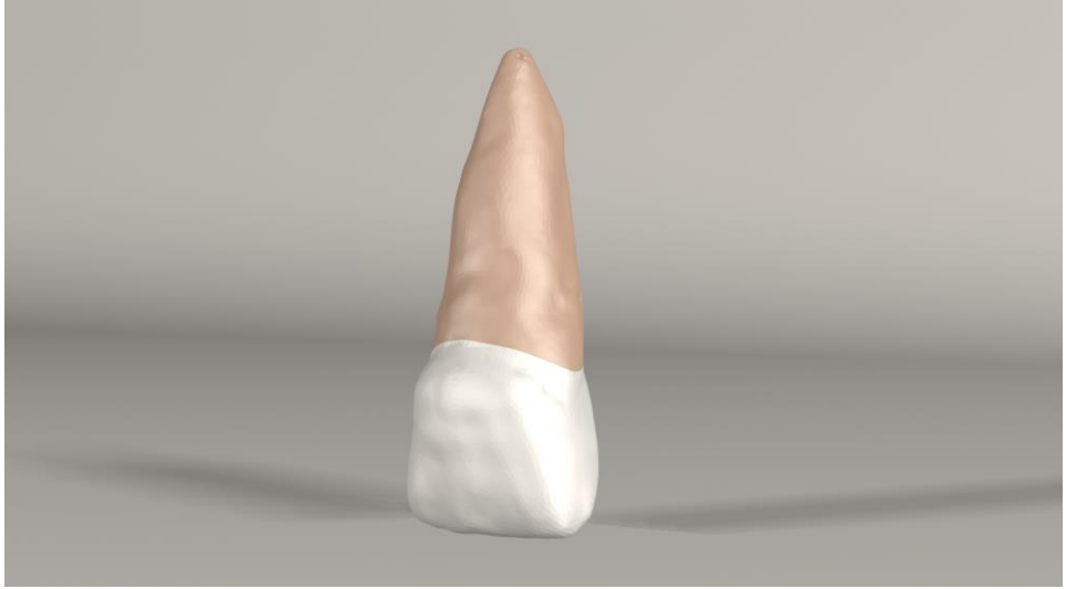
Şekil 10. Santral kesici dişin 3B sonlu elemanlar modeli
