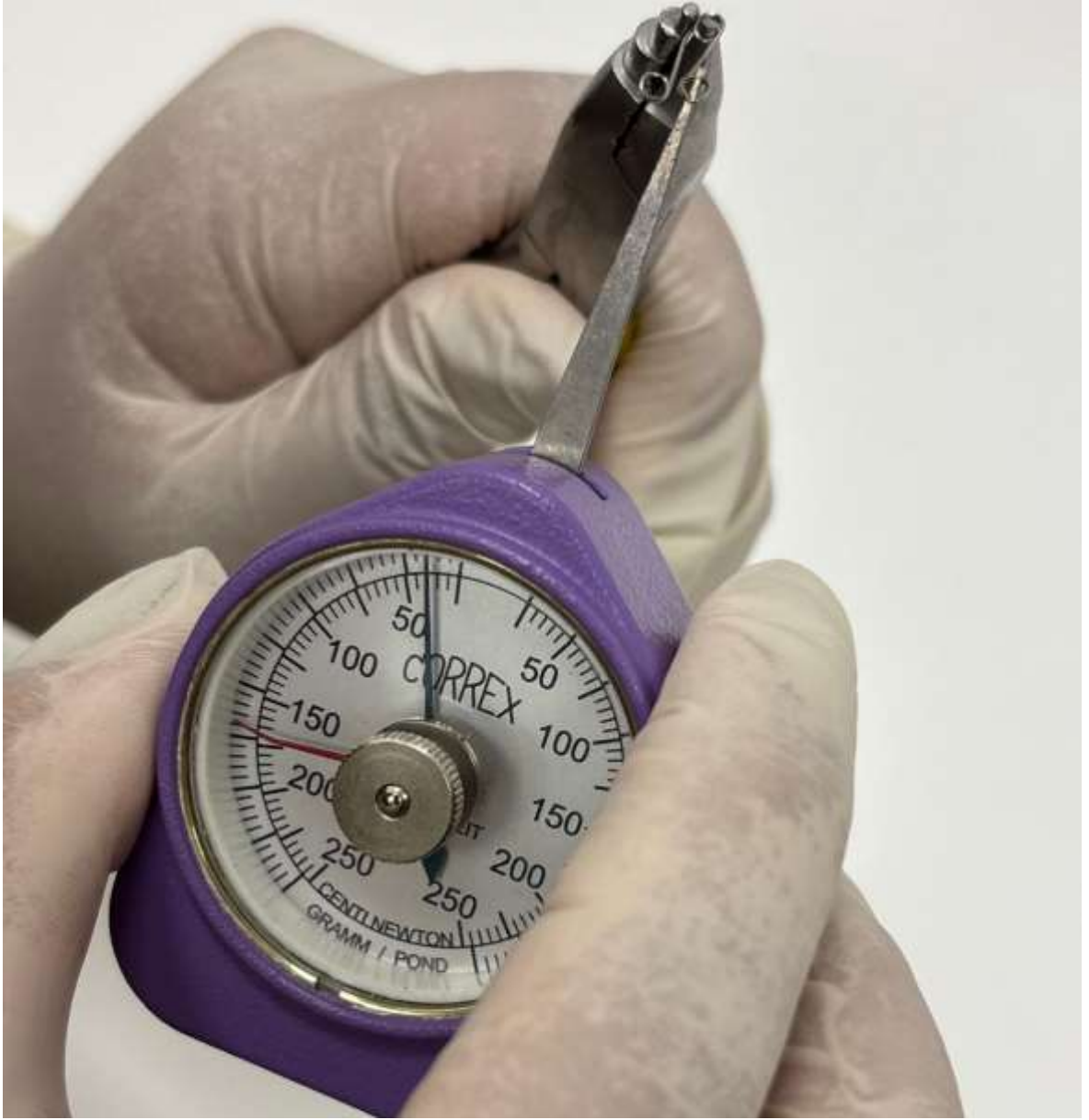
Şekil 3.11: Heliksli Zemberekte Kuvvet Ölçer (Correx Hahn Kolb, Stuttgart, Germany) ile 30g Kuvvet Ölçümü.
