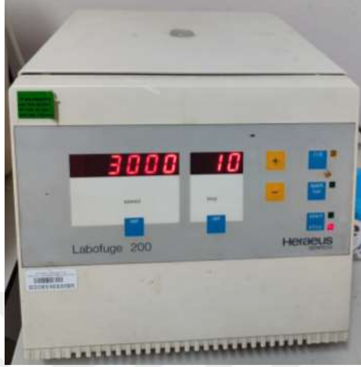
Şekil 3.15: Biyokimyasal Tüplerin Konulduğu Santrifüj Cihazı (Heraeus, Labofuge 200, Frankfurt, Germany).
