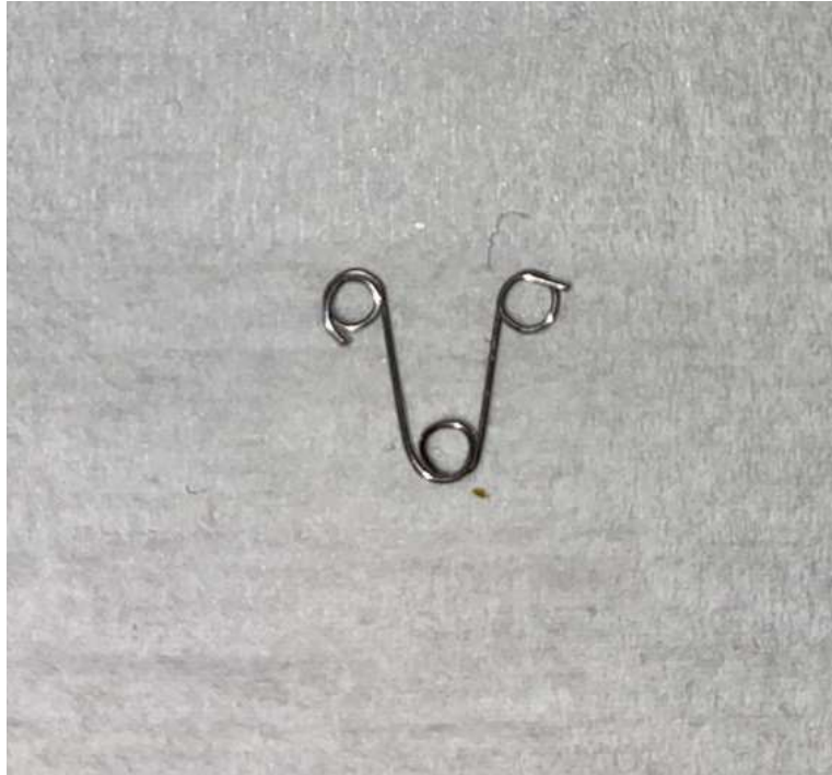
Şekil 3.9: 0.014-Inç Tam Yuvarlak Paslanmaz Çelikten Hazırlanan Heliksli Zemberek.
