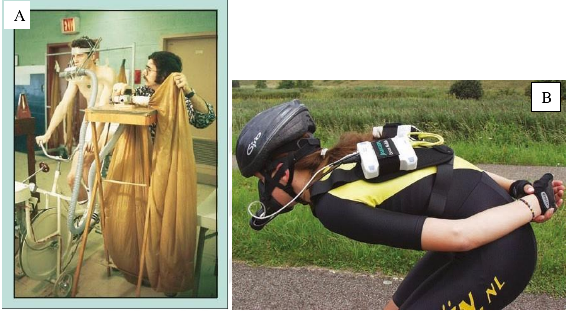
Şekil 12. Açık devre spirometri örneklerinden torba tekniği(A) ve bilgisayarlı sistem(B) (2)
