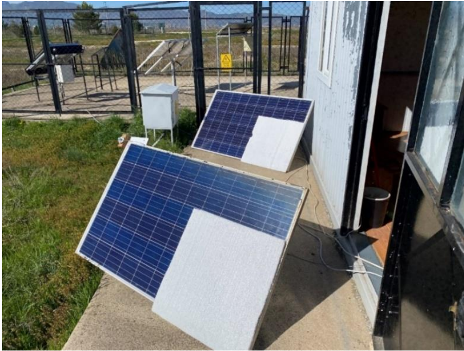
Şekil 4.4 Rastgele gölgelenmenin olduğu panellerin konumu.
