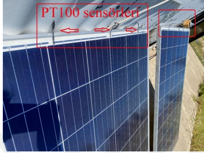
Şekil 3.16 PT100 sıcaklık sensörlerinin panel üzerindeki konumu.
