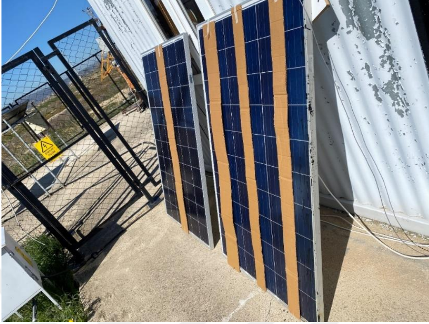
Şekil 4.15 Özdeş panellere uygulanan farklı gölgelenme koşulları.
