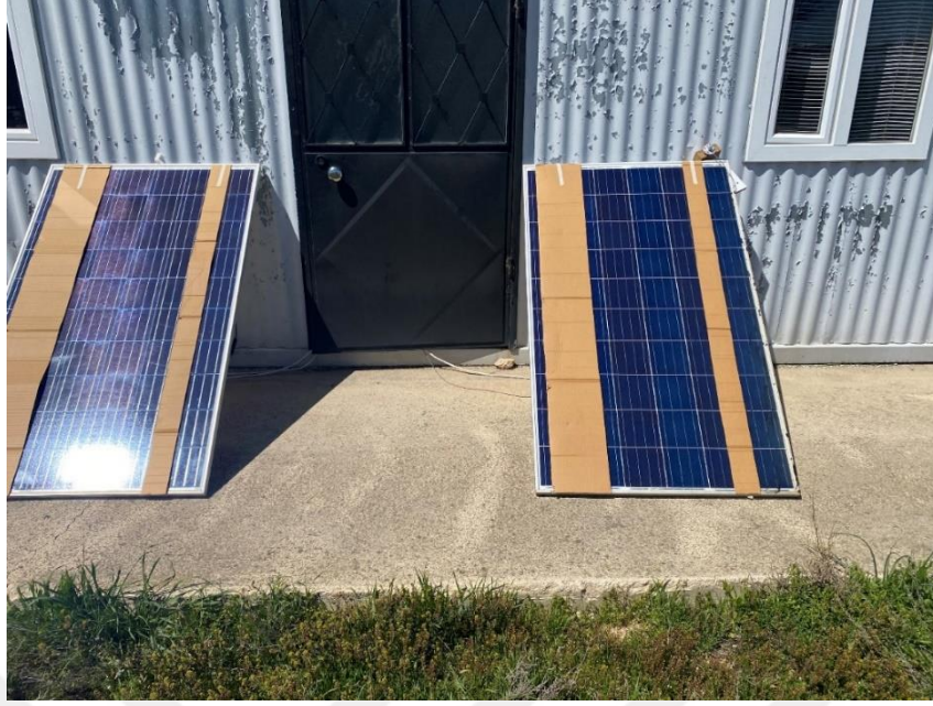
Şekil 4.9 İki hücre grubu için %30 ve %70 gölgelenmenin olduğu panellerin konumu.
