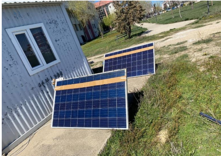
Şekil 4.6 Bir hücre grubu için %30 gölgelenmenin olduğu panellerin konumu.
