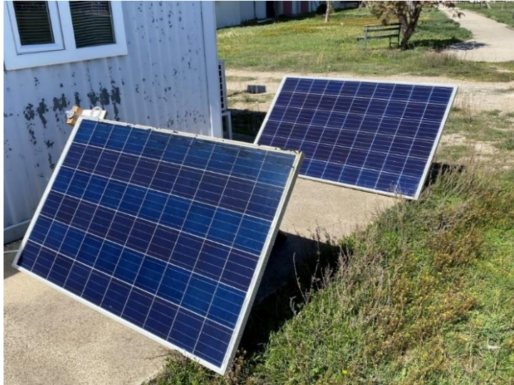
Şekil 4.1 Gölgelenme olmadığı durumdaki panellerin konumu.
