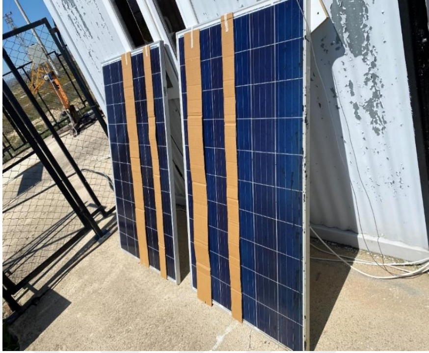
Şekil 4.12 İki hücre grubu için %30 ve %50 gölgelenmenin olduğu panellerin konumu.
