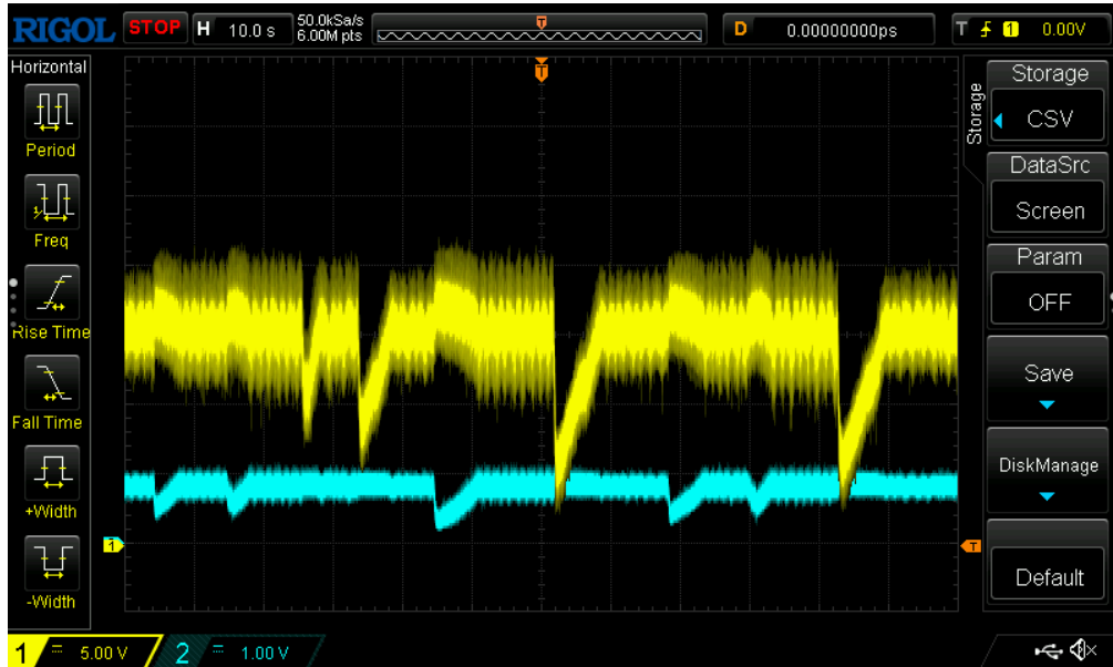
Şekil 4.14. INC algoritması 128 ortalama alma sayısı ve 1.1 ms dönüştürme süresi için gerilim ve akıma ait osiloskop görüntüsü
