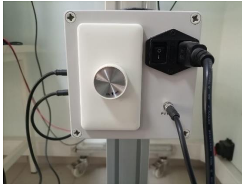
Şekil 3.24. Panelin ışınım miktarını değiştirmek için kullanılan UV lambaya ait ayar potu
