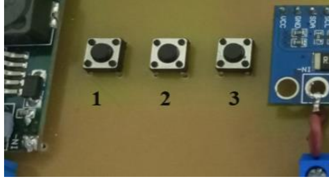
Şekil 3.21. Devrede kullanılan fonksiyon butonları
