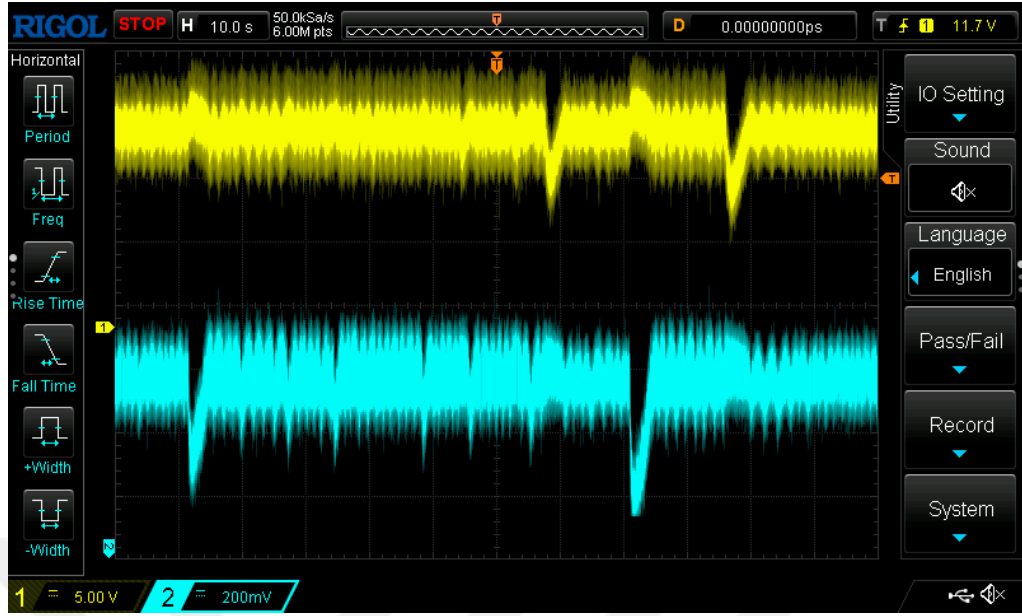
Şekil 4.13. INC algoritmasına göre 64 ortalama alma sayısı ve 2.116 ms dönüştürme süresi için osiloskop gerilim ve akım görünümü
