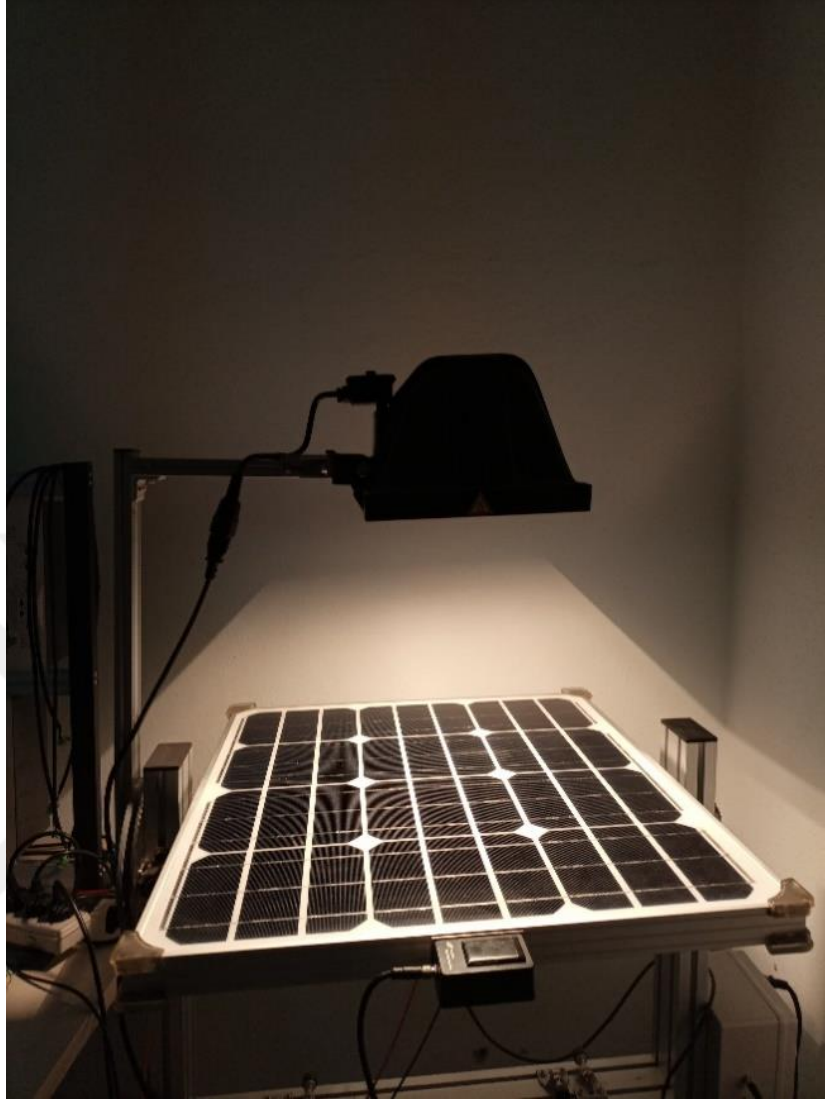
Şekil 3.26. UV lamba ve fotovoltaik panel
