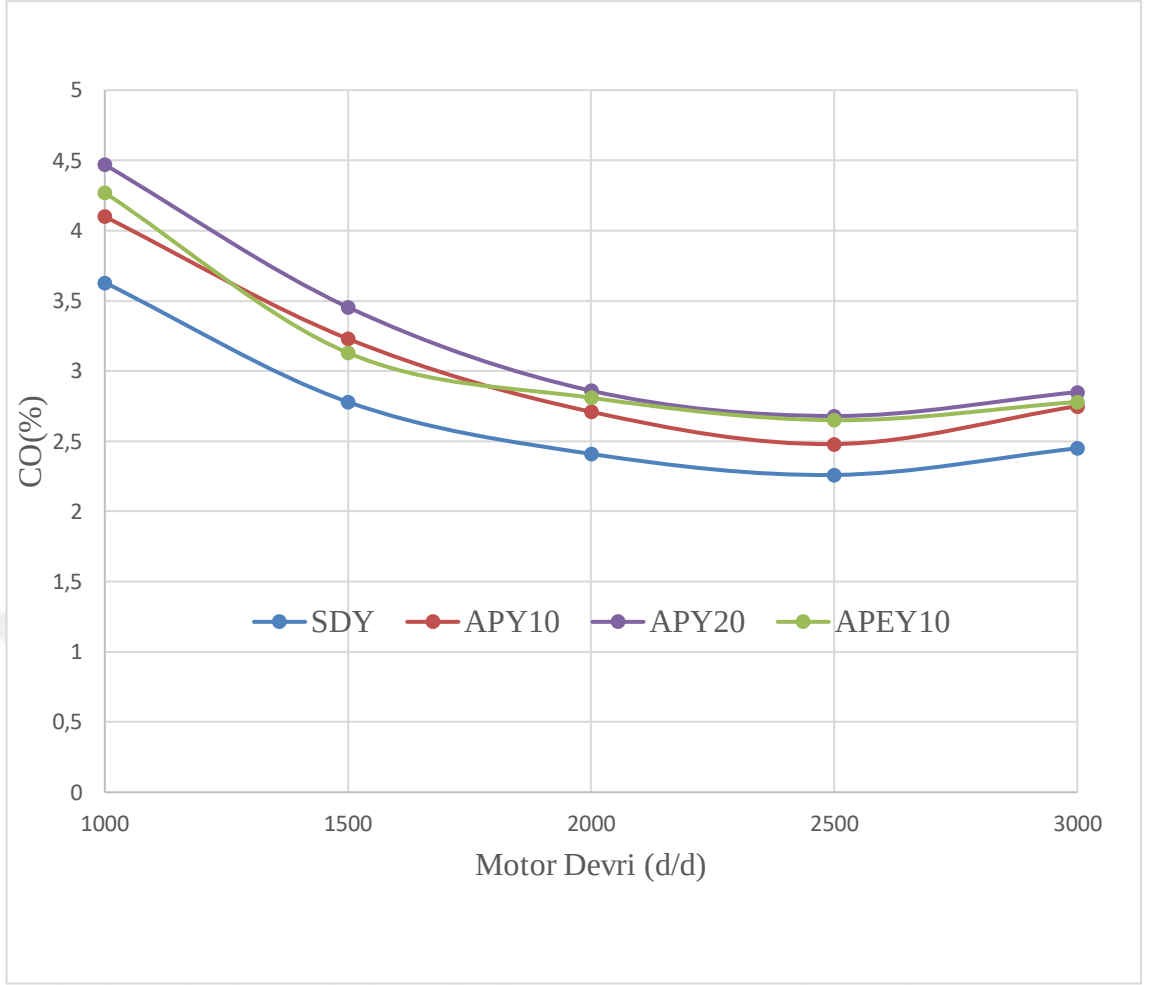
Şekil 4.4 Farklı oranlarda atık plastik kaynaklı yakıt kullanımının CO emisyonuna etkisi
