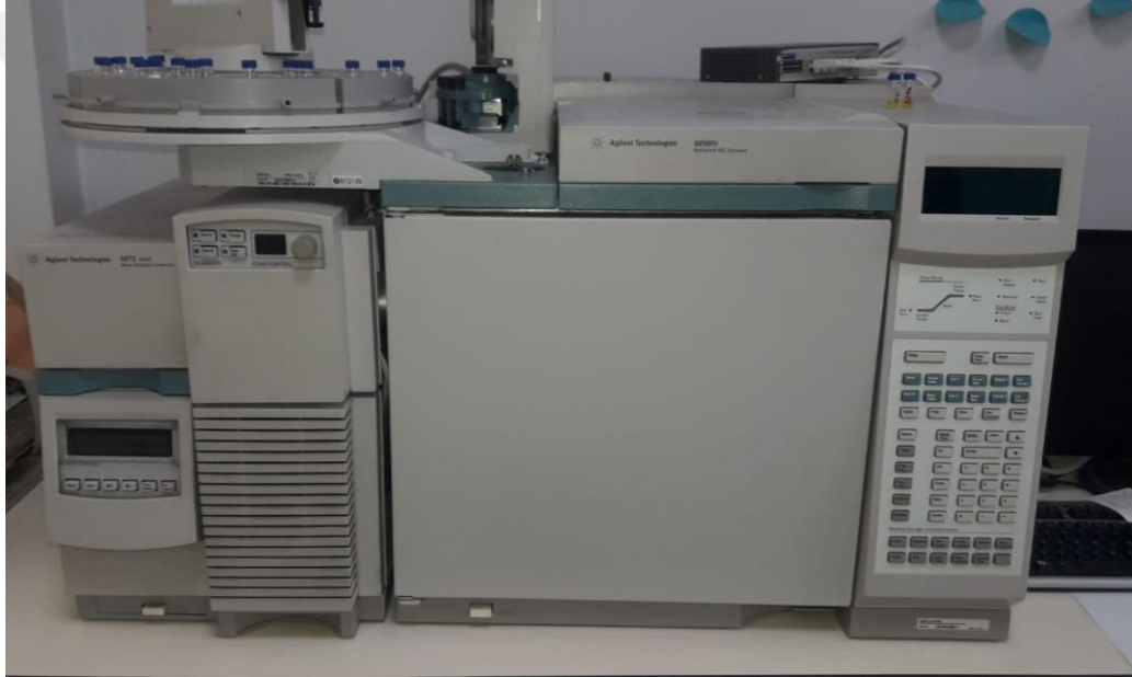
Şekil 3.6. Uçucu yağ analiz işlemlerinde kullanılan Gaz Kromatografisi - Kütle Spektrometresi (GC-MS) cihazı.
