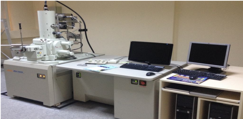
Şekil 2.12. Hazırlanan örneklerin teşhis edilmesi ve fotoğraf çekimlerinin yapılması için kullanılan Elektron Mikroskobu
