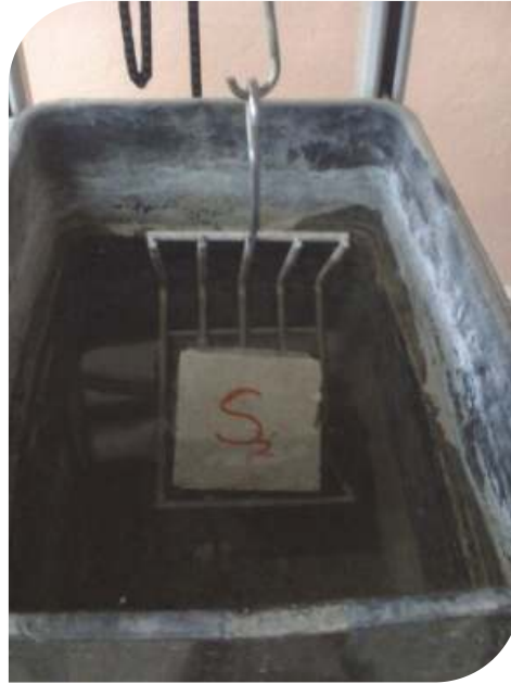
Resim 4.1. Sertleşmiş Betonun Yoğunluğunun Tayini Numunesi
