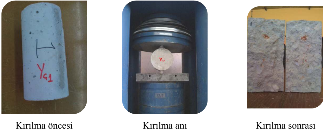
Resim 4.5. Yarmada Çekme Dayanımı Beton Numuneleri
