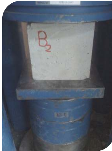
Resim 4.3. Betonbasınç Dayanımı Numunesi
