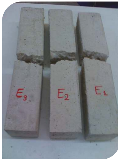
Resim 4.4. Eğilme Deneyi Sonucu Oluşan Kırılma
