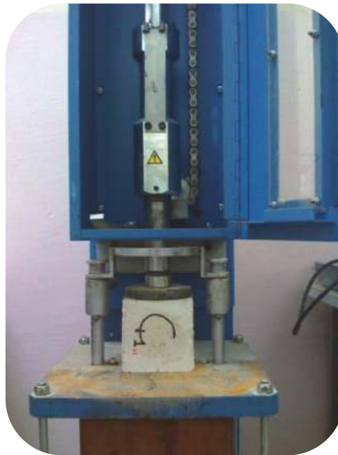
Resim 4.6. Çarpma Etkisi Deney Aleti
