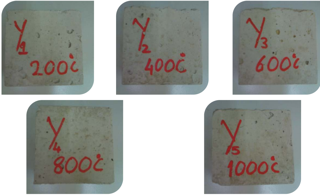
Resim 4.9. Sıcaklık Etkisi Deney Numuneleri
