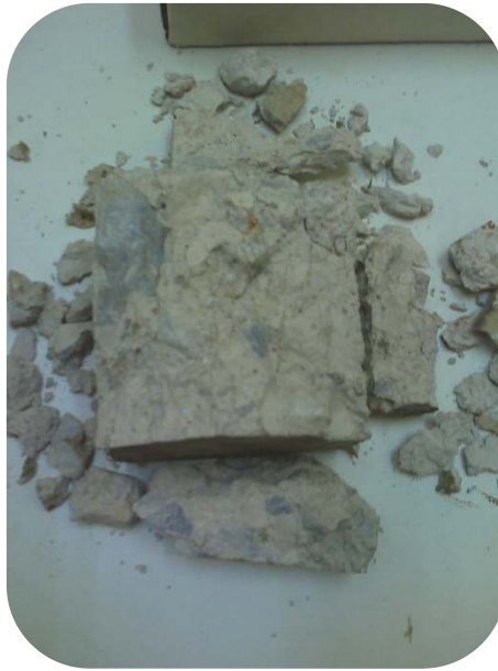
Resim 4.8. Çarpma Etkisi Sonucu İflas Eden Numune
