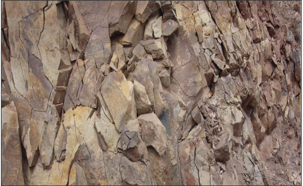
Resim 5.3. T2 Tüneli giriş kesimi üstünde (Km 88+620) yer alan Hasaelebi Volkanitleri (Kha) ierisindeki ok zayıf dayanımlı Aglomeratik - Andezitik Breşik Tüflere ait görünüm
