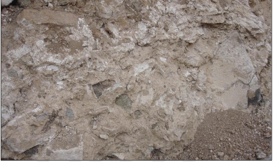
Resim 5.3. T2 Tüneli giriş kesimi üstünde (Km 88+620) yer alan Hasaelebi Volkanitleri (Kha) ierisindeki ok zayıf dayanımlı Aglomeratik - Andezitik Breşik Tüflere ait görünüm
