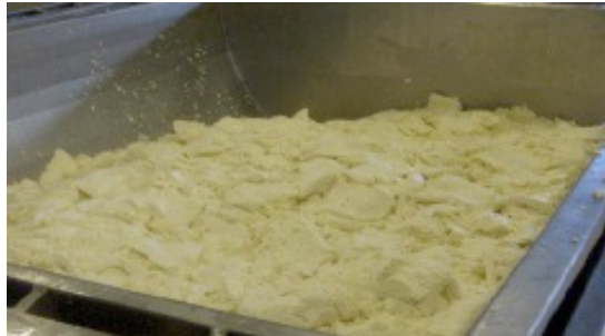
Fotoğraf 8. Haşlama makinasına alınan teleme
