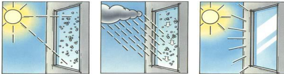
Şekil 4.4. Fotokatalik bozunma yoluyla kendi kendini temizleyen cam (Leydecker, 2008: 73)
