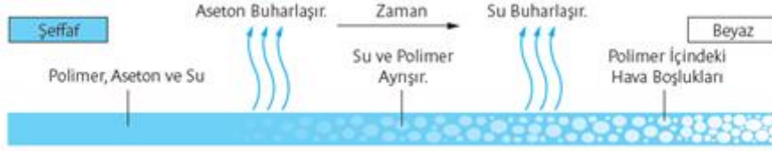
Şekil 4.17. Süper serin boyanın çalışma düzeneği (Mandal ve diğerleri, 2018: Ocak, 2020)
