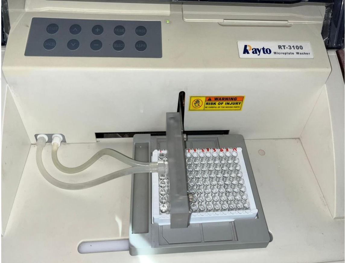
Şekil 3. 13: ELİSA kiti mikrolâkalarının otomatik ELİSA mikrolâka yıkayıcısıyla (Rayto RT-3100 Microplate Washer) yıkanması.
