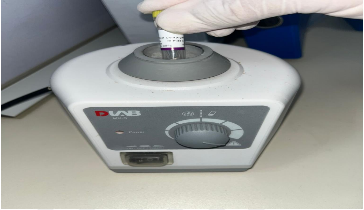
Şekil 3. 11: Standart tozunun santrifüj edilerek hazırlanması.
