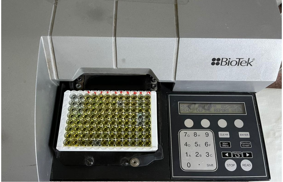
Şekil 3. 16: Kitlerin ELİSA cihazında (BioTek® ELx800) analiz edilmesi.
