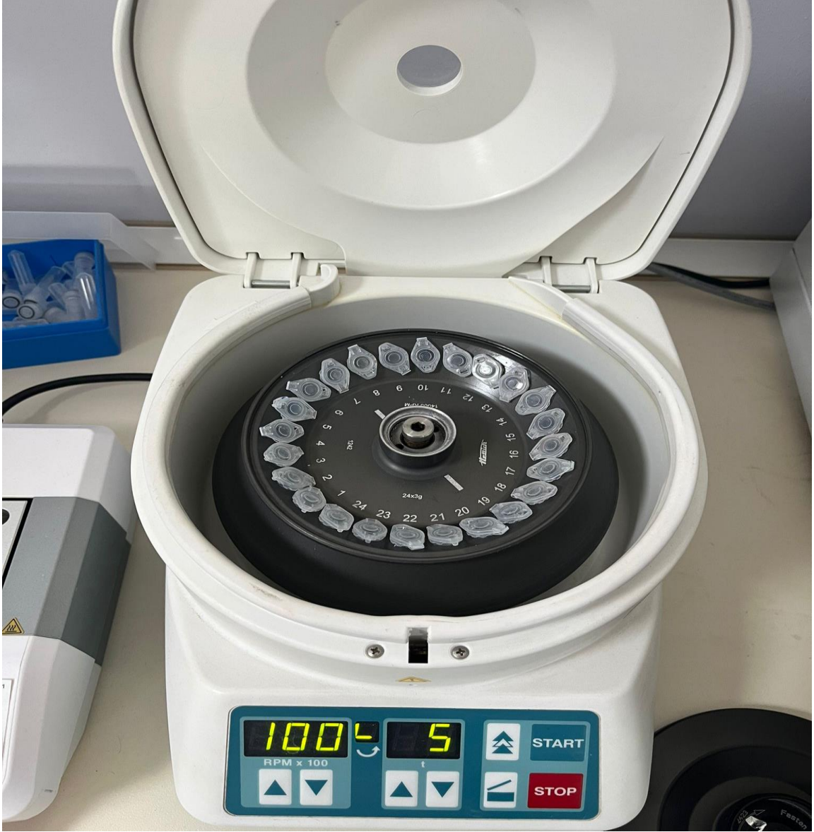
Şekil 3. 10: Tükürük numuneleri 1000G’ de 5 dakika santrifüj edilmesi.
