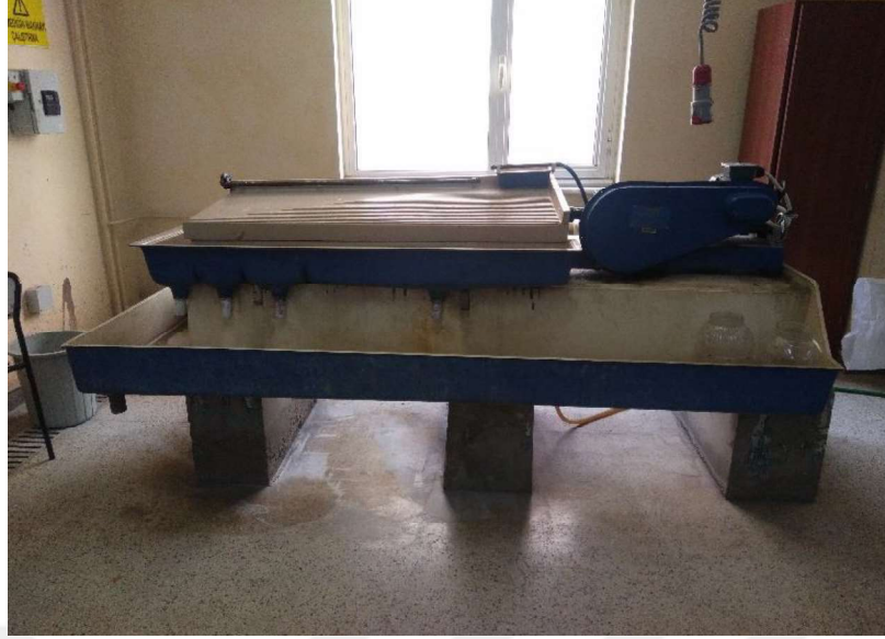
Şekil 4.12 DEU Maden Mühendisliği Bölümü Cevher Hazırlama ve Zenginleştirme Laboratuvarına ait Denver Wilfley laboratuvar tipi sallantılı masa (Kişisel arşiv, 2018)
