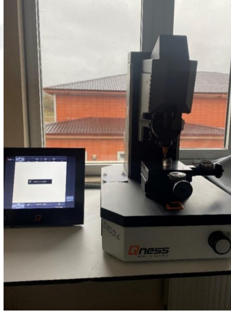
Şekil 3.2: QNESS marka vickers sertlik ölçüm cihazı.
