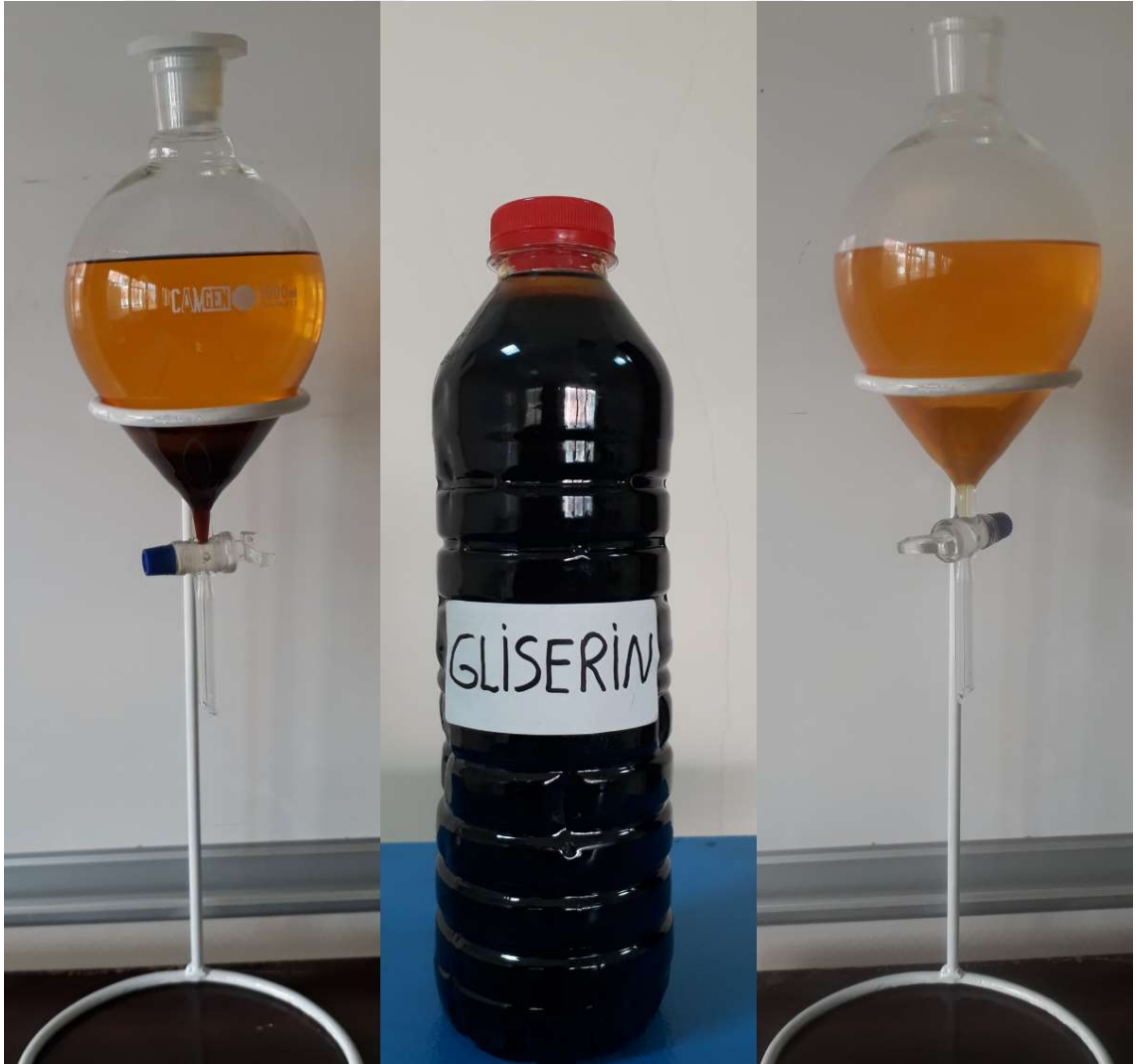
Şekil 6.4. Gliserinin yağ esterinden uzaklaştırılması
