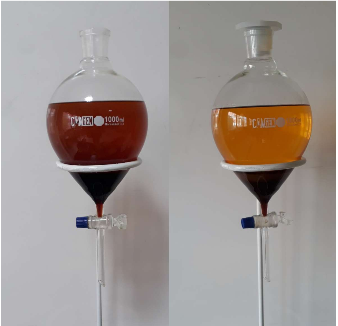
Şekil 6.3. Gliserin ve metil esterinin ayrılması
