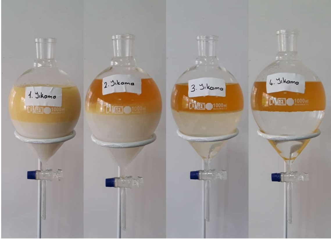
Şekil 6.6. Biyodizel yıkama aşamaları
