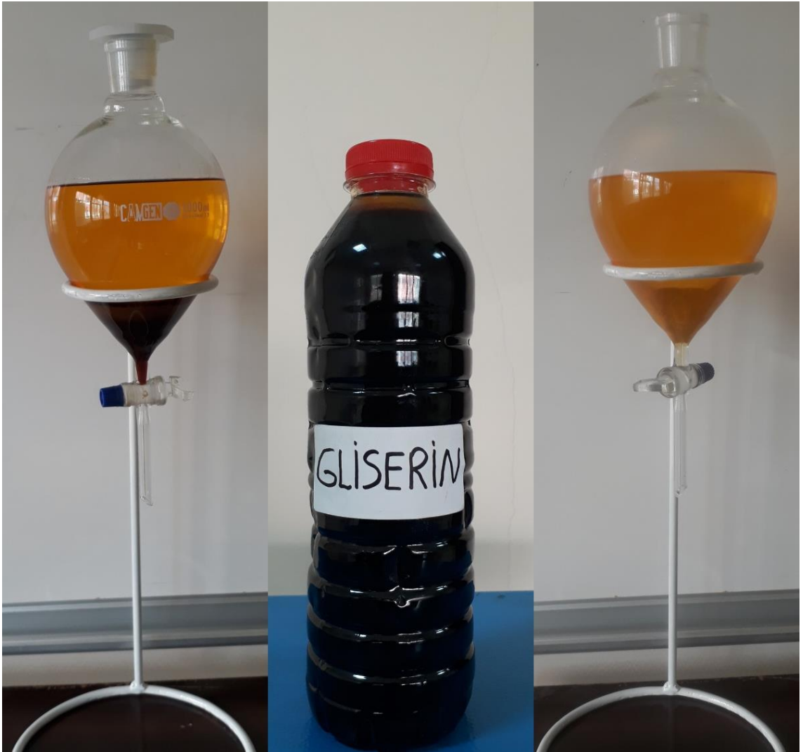
Şekil 6.4. Gliserinin yağ esterinden uzaklaştırılması
