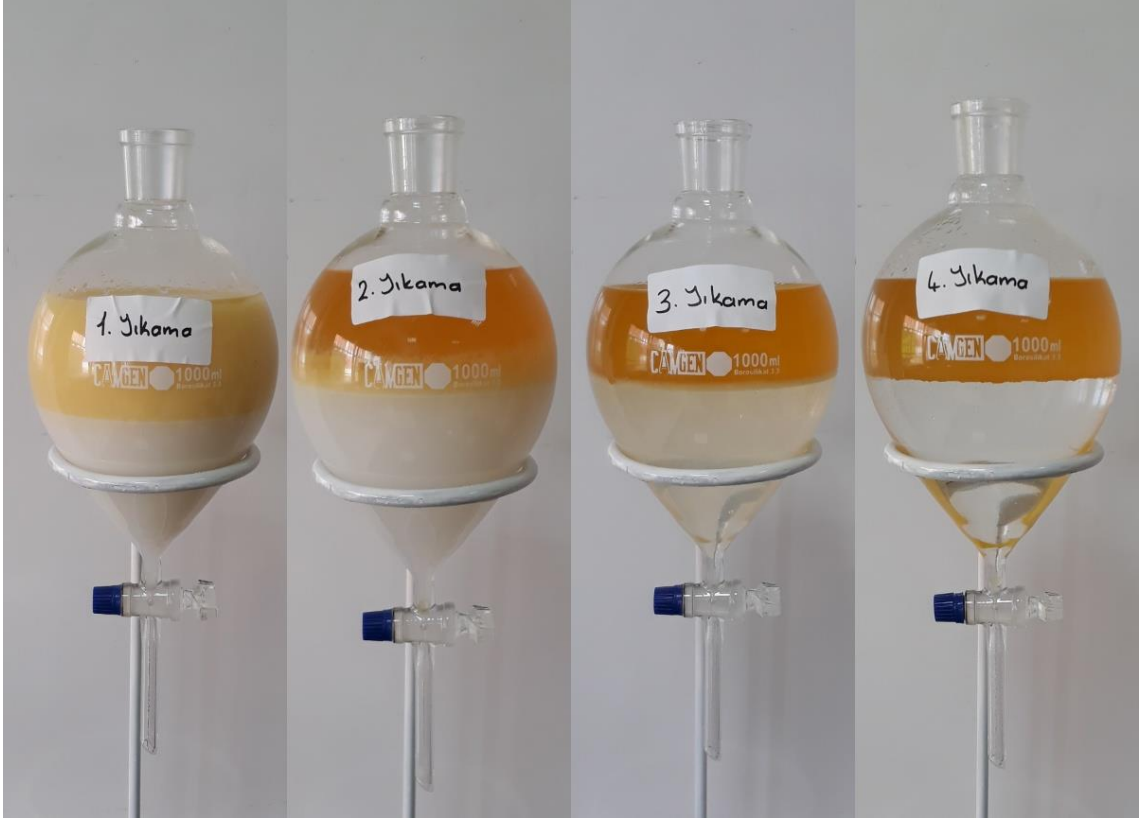
Şekil 6.6. Biyodizel yıkama aşamaları
