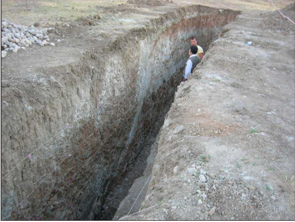
Şekil 5.13 Mugirtepe fay segmenti üzerinde paleosismoloji amaçlı açılan hendeği ve hendek içerisindeki fayı gösteren arazi fotoğrafı.
