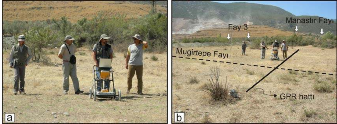
Şekil 1.9 a) Hendek-1 alanında yapılan GPR çalışmalarını gösteren arazi fotoğrafı b) olası fay izini ve GPR hattını gösteren arazi fotoğrafı.
