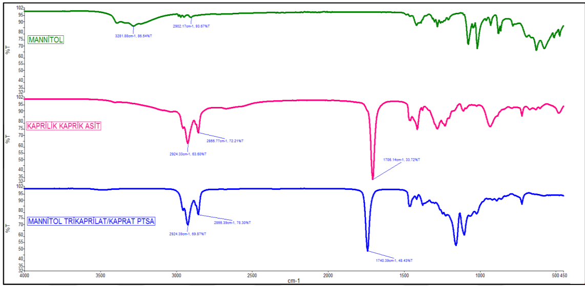
Şekil 3.19. p-Toluen sülfonik asit ile sentezlenen Mannitol Trikaprilat/kaprat esterinin FTIR spektrumunun mannitol ve kaprilik kaprik asitin FTIR spektrumlarıyla karşılaştırılması.
