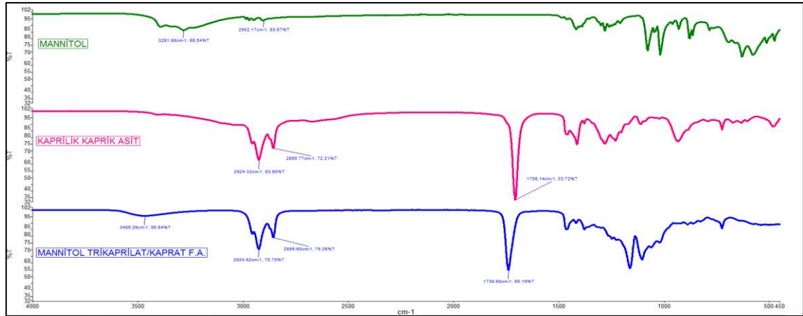
Şekil 3.18. Fosforik asit ile sentezlenen Mannitol Trikaprilat/kaprat esterinin FTIR spektrumunun mannitol ve kaprilik kaprik asitin FTIR spektrumlarıyla karşılaştırılması.
