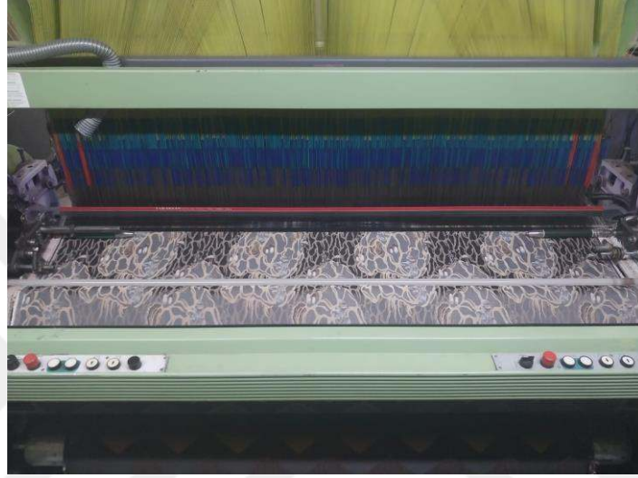
Görsel 4.13. Misera'nın dokuma işlemi sırasında tezgâhta görünümü. (Seda Uçar fotoğraf arşivi, 2025).
