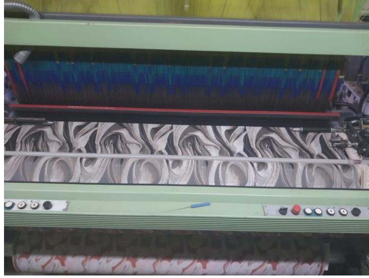
Görsel 4.34. Buhur'un dokuma işlemi sırasında tezgâhta görünümü. (Seda Uçar fotoğraf arşivi, 2025).
