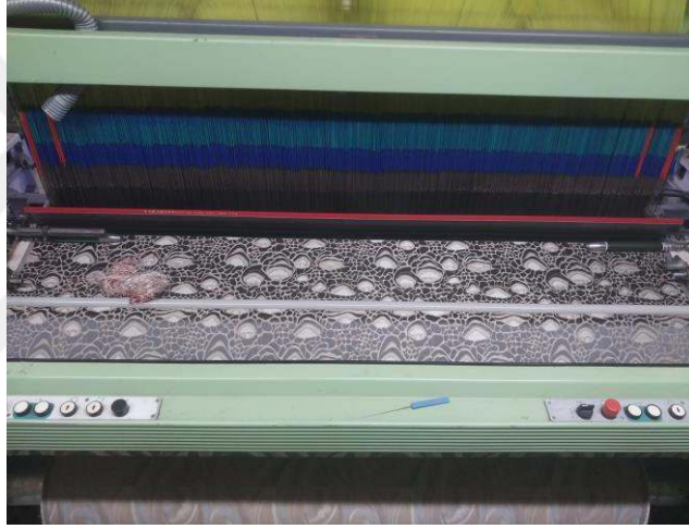
Görsel 4.27. İlme 'nin dokuma işlemi sırasında tezgâhta görünümü. (Seda Uçar fotoğraf arşivi, 2025).
