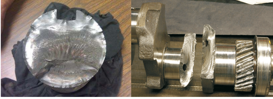
Şekil 5.5 Millerde yorulma hasarı sonucu kırılma yüzeyleri [41].
