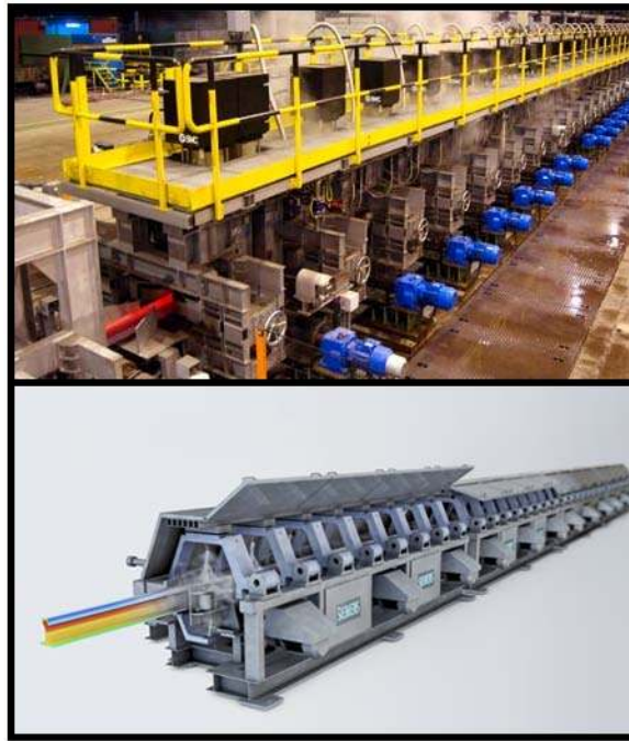
Şekil 4.6 “In-line” tipi su verme sistemi [38].
