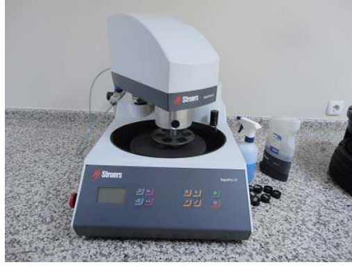
Şekil 7.5 Struers Tegrapol 21 Tegraforce 5 marka otomatik parlatma cihazı
