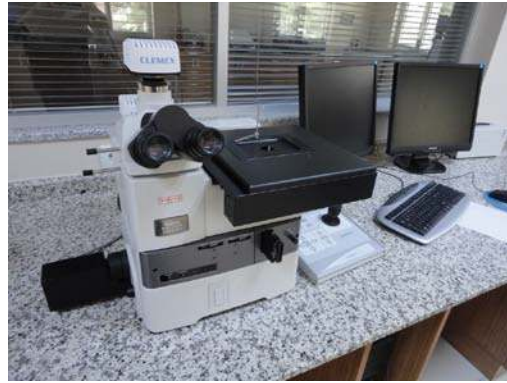
Şekil 7.6 Nikon Eclipse MA 200 model optik mikroskop
