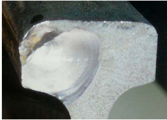
Şekil 6.2 Ray mantarında yorulma hasarı [51].
