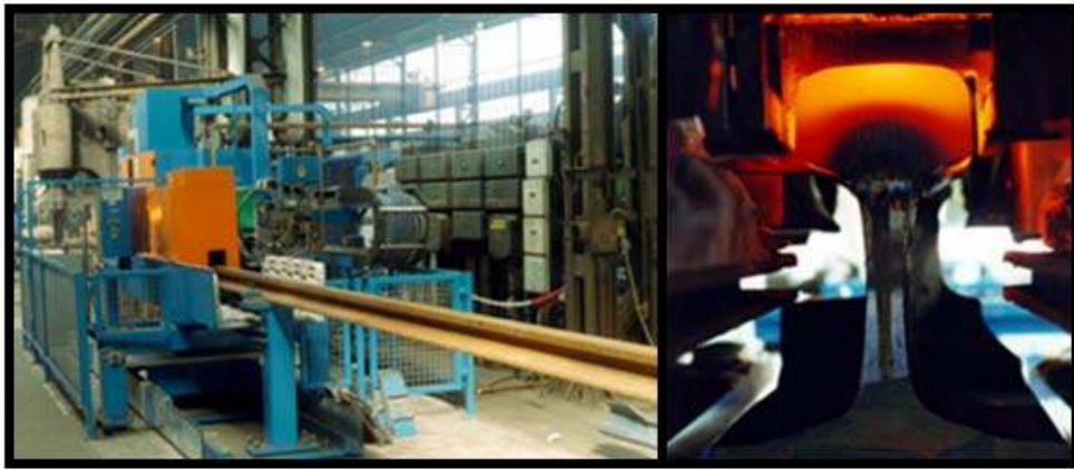
Şekil 4.7 “Off-line” tipi su verme sistemi [38].
