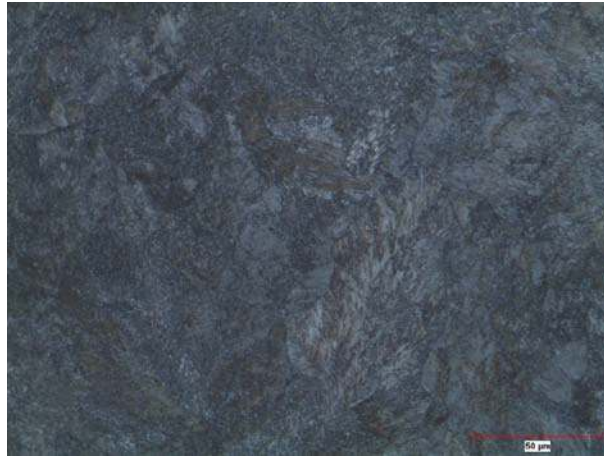
Şekil 8.4 R260 kalite ray çeliğine ait RS bölgesinden 500X büyütmede mikroyapı resmi.
