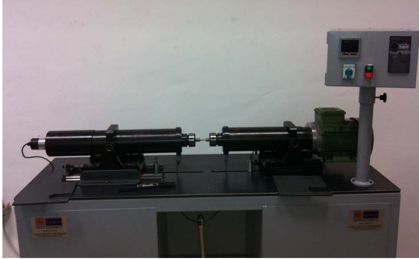
Őekil 7.11 Dnel eęmeli yorulma cihazı
