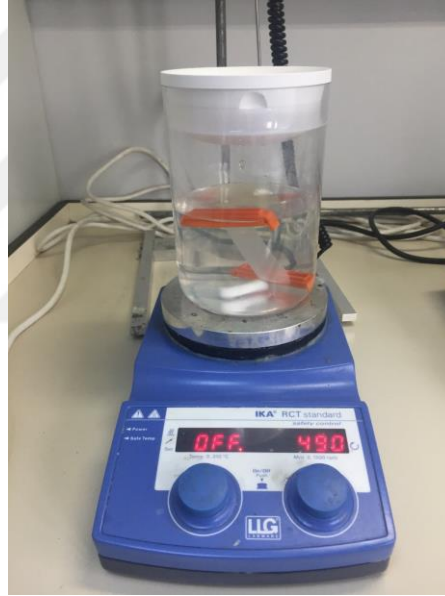
Şekil 3.2: Diyaliz torbası ile in-vitro salım
