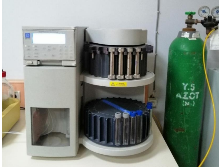
Şekil 3.4. Dionex ASE 200 basınçlı sıvı ekstraksiyonu sistemi
