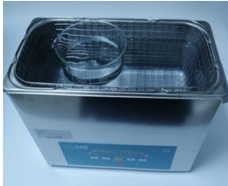
Şekil 2.6 . Ultrasonik banyo çözünmüş havanın uzaklaştırılması
