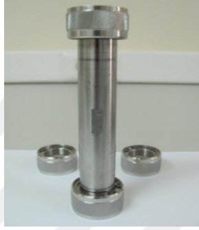
Şekil 3.3. Çelik ekstraksiyon hücreleri
