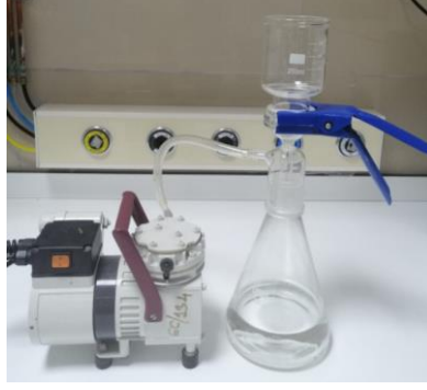
Şekil 2.5. HPLC özel süzme sistemi
