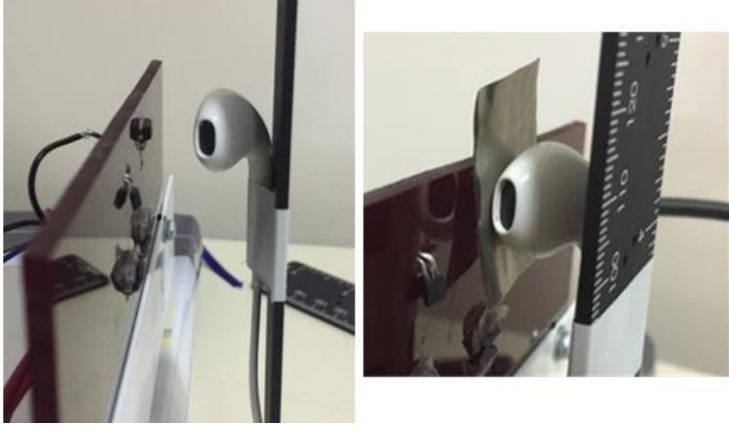
Şekil 3.14 Apple kulaklık ölçüm düzeneği
