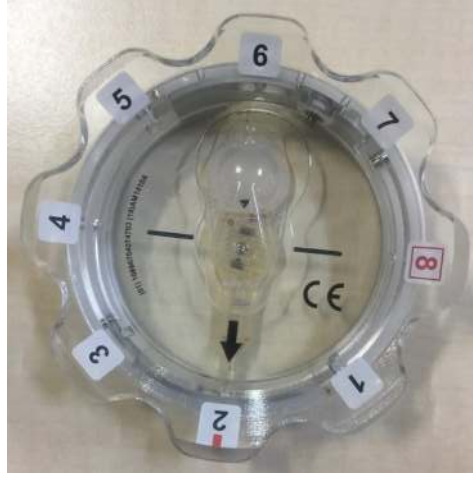
Şekil 3.4 Konumlandırma aracının valf üzerine yerleştirilmesi [38]
