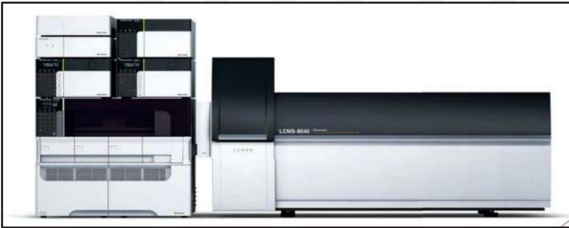
Şekil 1.9. Çalışmada kullanılan Shimadzu marka 8040 model LC-MS/MS cihazı (Shimadzu 2016)
