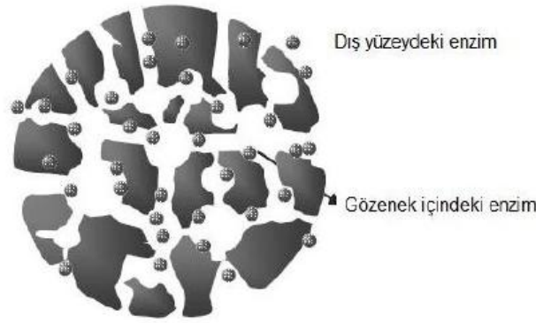
Şekil 2.8. Gözenekli destek maddesinin iç ve dış yüzeyi
