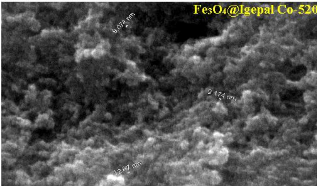
Şekil 5.2. \text{Fe}_3\text{O}_4 ile \text{Fe}_3\text{O}_4@ Igepal Co-520 FESEM görüntüsü
