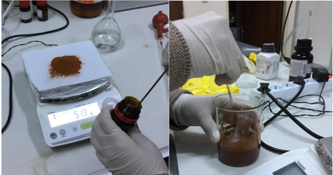
Şekil 3.2. Hassas terazi ile partikül ölçümü ve homojenizatör öncesi temel akışkan ile karıştırma işlemi
