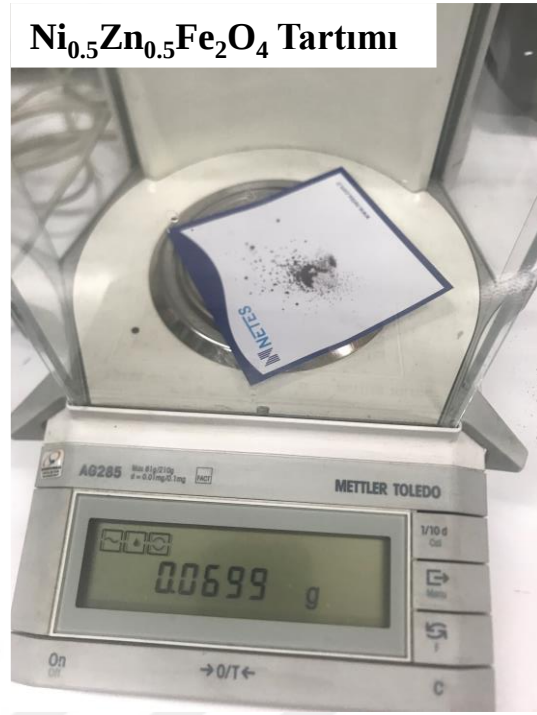
Şekil 5: EM Soğurma Ölçümler için wt% Ağırlık Tartım Görselleri
