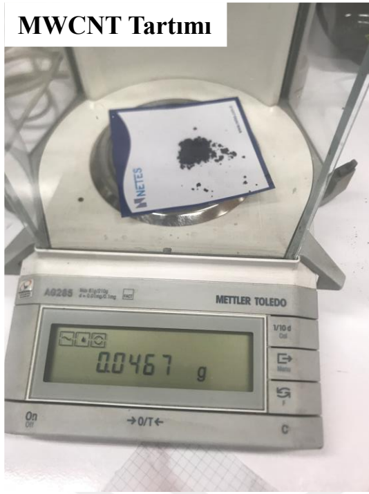
Şekil 5: EM Soğurma Ölçümler için wt% Ağırlık Tartım Görselleri
