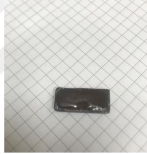
Şekil 8: EM Soğurma Ölçümleri Sonunda Dalga Kılavuzundan Çıkartılmış Numune Görselleri
