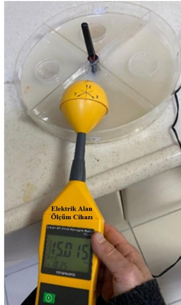
Şekil 3.3 Mikrodalga Maruziyet Ortamı (a) Çalışma Grupları ve Thermocouple Kaydı (b) Elektrik Alan Ölçümü
