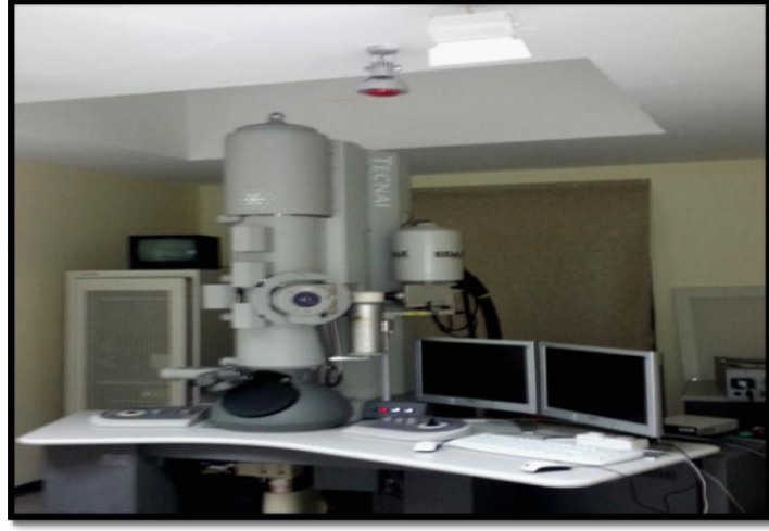
Şekil 3.9 TECHNAI marka TEM mikroskobu [4].
