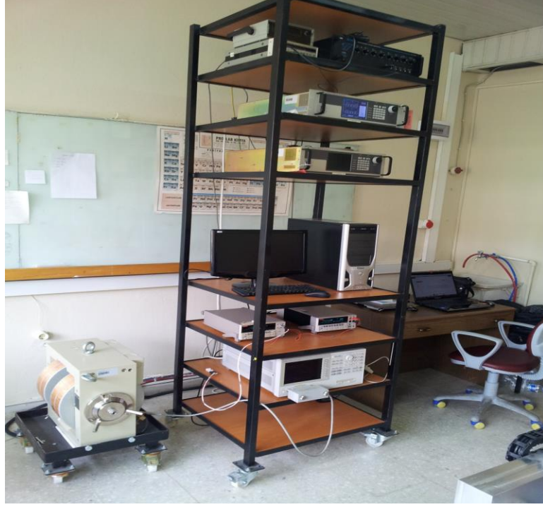
Şekil 3.14 Laboratuvarımızda bulunan manyetodirenç ölçüm sistemi.
