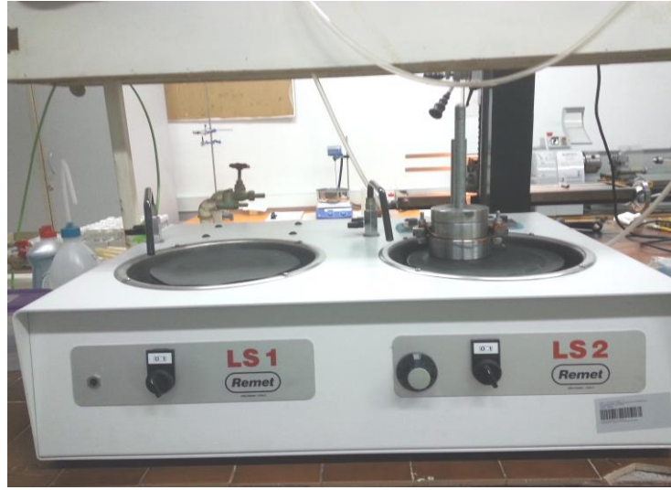
řekil 3.11 Laboratuvarımızda mevcut olan poliř sisteminin fotoęrafı.
