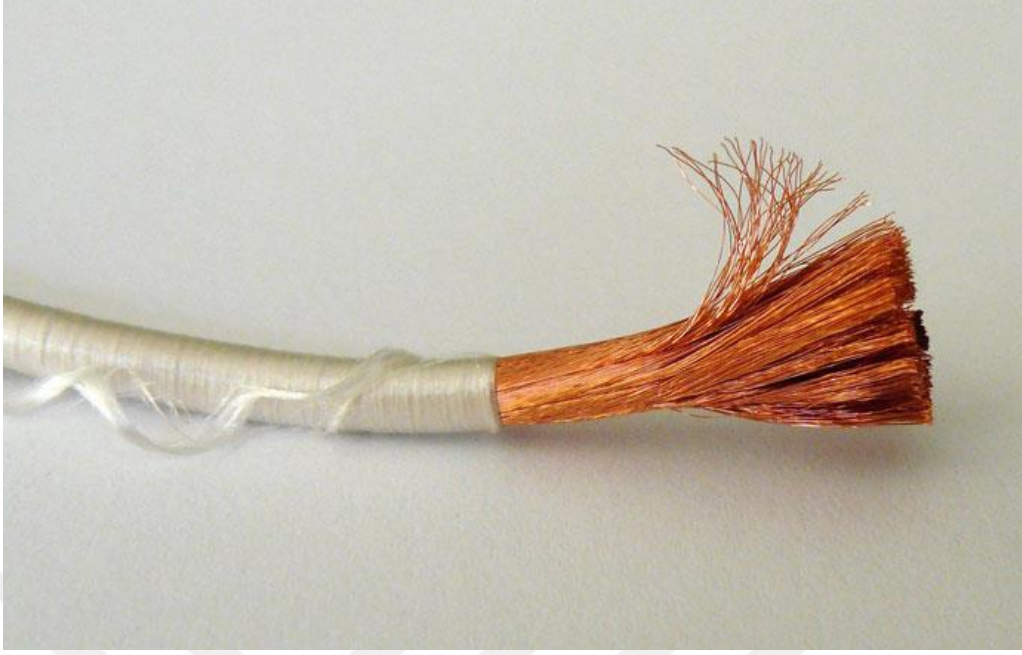
Şekil 2.17. Her biri 50 \mu m 'lik bir çapa sahip 2.000 iplikten oluşan örnek bir Litz tel. Her tel ince bir cila katıyla izole edilmiştir (Kaden 1959).
