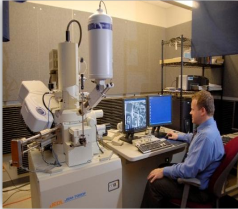
Şekil 2.13. Taramalı elektron mikroskopu (SEM) sistemi ve sistemin iç yapısı ( http://caf.ua.edu , http://wsm.wsu.edu )
