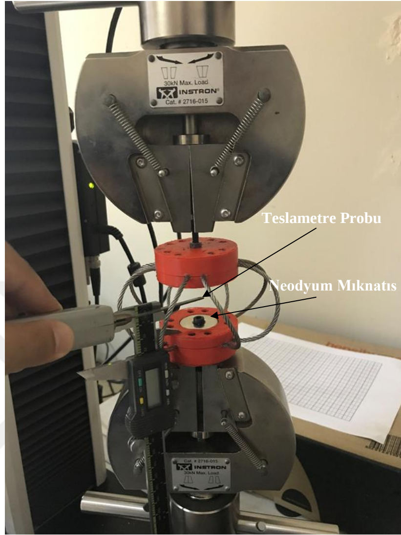
Şekil 3.5. M3 modelinin yarı-statik deneylerdeki orta noktadaki manyetik alan şiddetinin ölçümü
