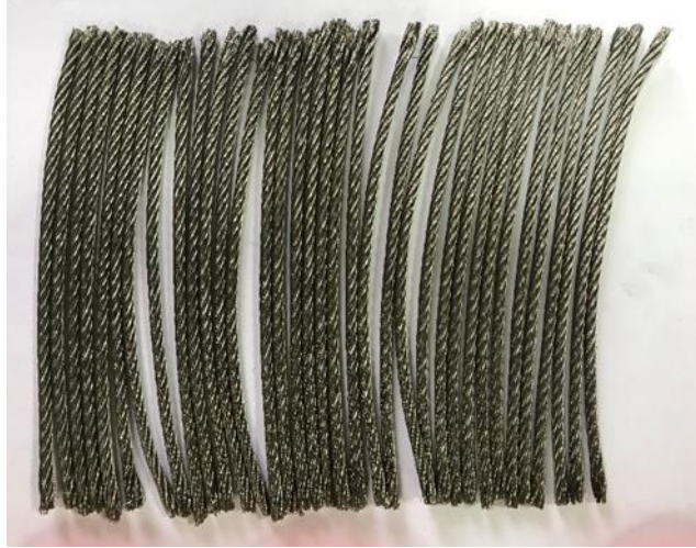
Şekil 1.9. MSÇHTİ’de kullanılan 7x19S paslanmaz çelik halatlar
