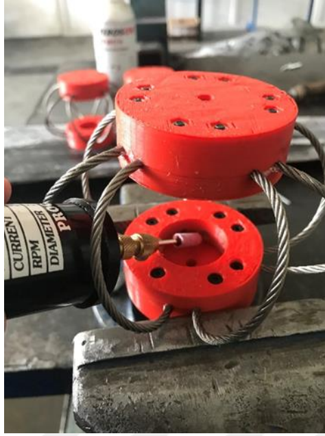
Şekil 2.7. Mıknatıs yuvalarının yüzey temizleme işlemi
