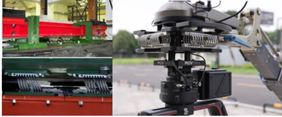
Şekil 1.11. WR izolatörü kayan zemin uygulamaları
