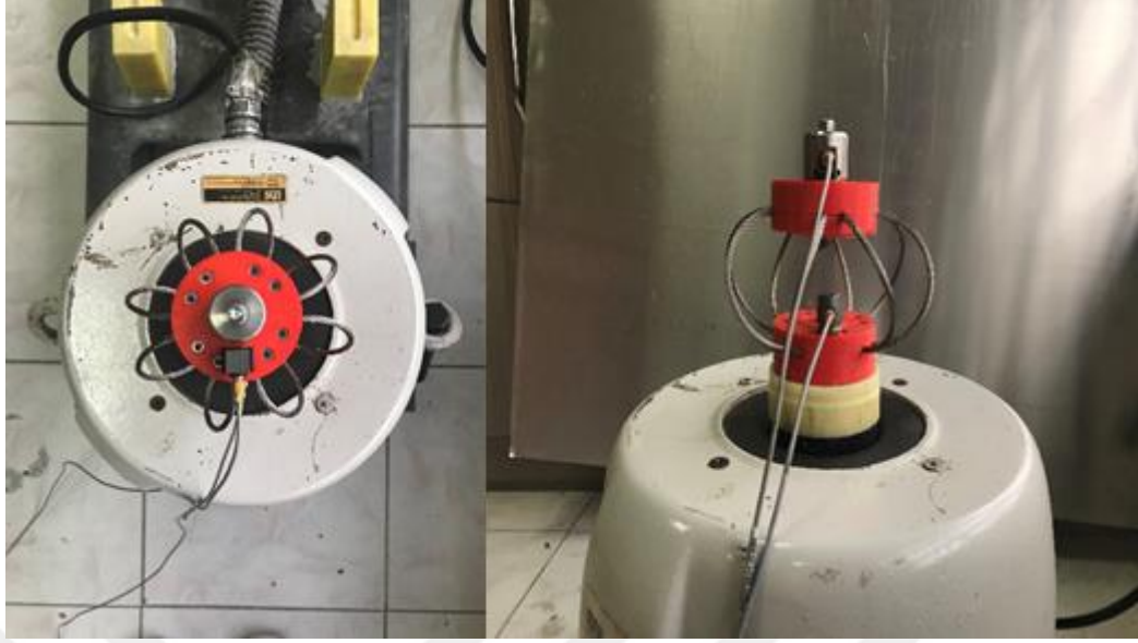
Şekil 4.3. MSÇHTİ sarsıcı test düzeneği
