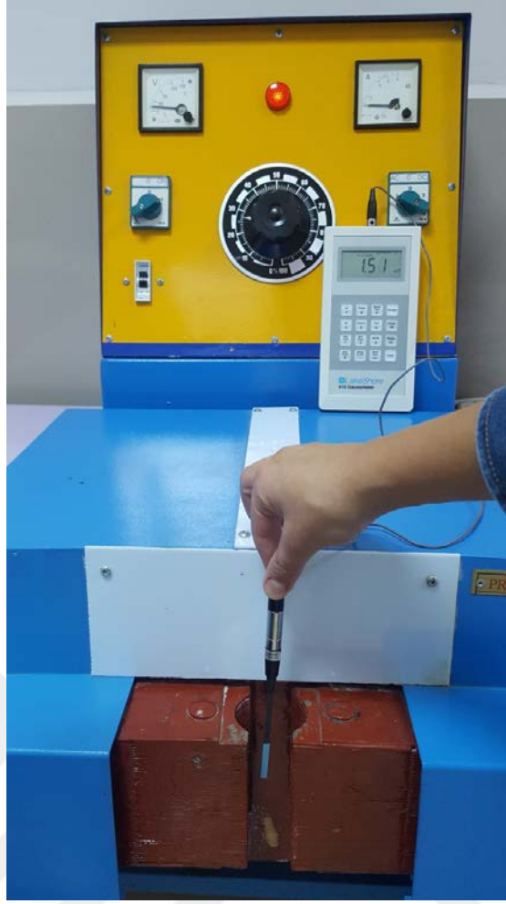
Şekil 3.11. Radyal manyetik alan oluşturan elektromanyetik alan düzeneği
