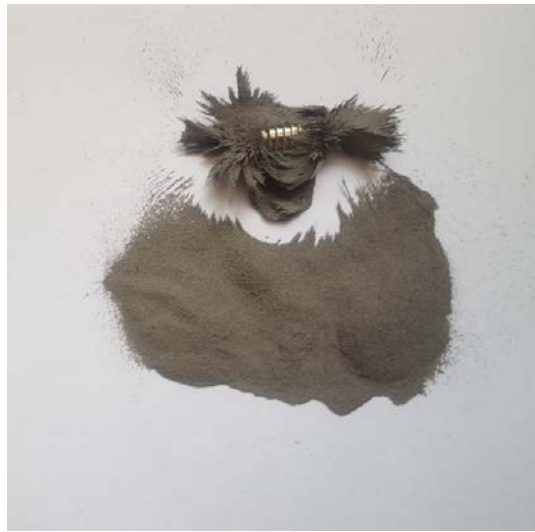
Şekil 3.4. Öğütülmüş saf demir tozunun neodyum mıknatısla etkileşimi
