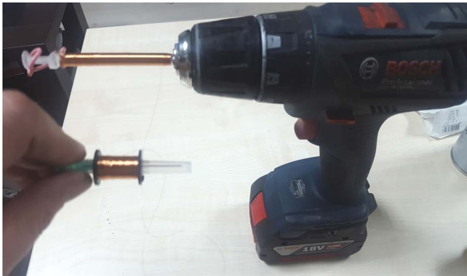
Şekil 3.5. Primer sargının şarjlı matkap yardımıyla şırınga gövdesine sarımı
