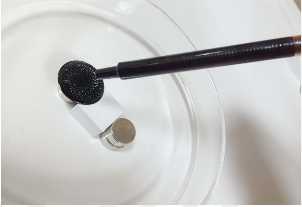
Şekil 4.10. Sabit yuvarlak geometrili neodyum mıknatısların etkileşimi altında manyetik sıvının tutulması
