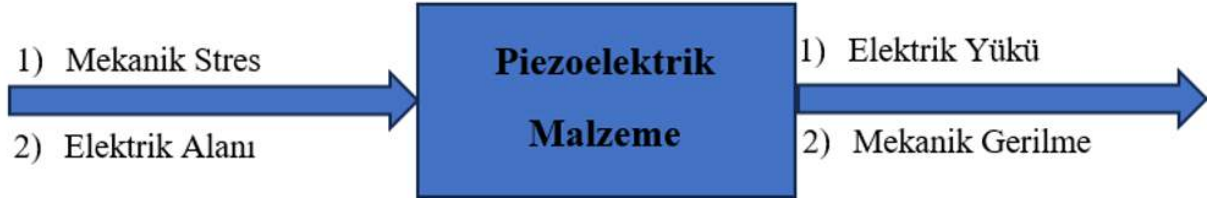
Şekil 2.3. Piezoelektrik malzemelerin giriş/çıkışı (Behera, 2022a).
