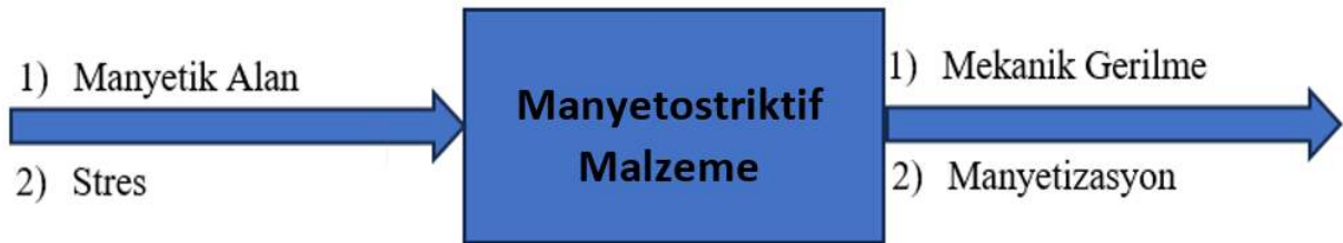
Şekil 2.6. Manyetostriksiyon etkisi: Gerilme ile manyetik alan arasındaki ilişki (Behera, 2022b).
