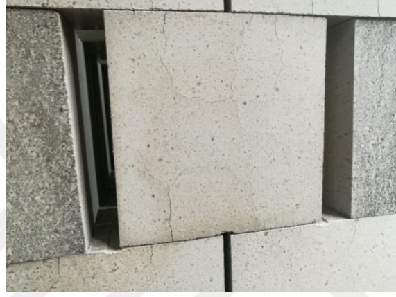
Şekil 5.5. Magnezyum Sülfat Preslenme Sonrası Çatlak ve Şişme Görünümü
