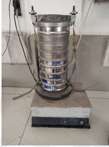
Şekil 5.20. Elek Analizi Test Düzeneği
