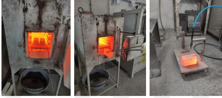
Şekil 5.24. Termal Şok Test Basamakları (Numunelerin Fırından Alınması ve Üfleme Basamağı)
