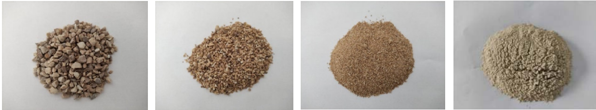
Şekil 5.2. Deniz Suyu Sinter Manyezit Fraksiyonların Görünümleri (3-5 mm, 1-3 mm, 0-1 mm, Toz)
