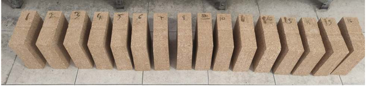
Şekil 5.18. Oluşturulan Kompozisyonların Pişirme Sonrası Görünümü
