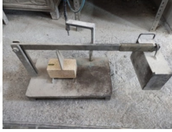
Şekil 5.25. Termal Şok Testi, Yük Uygulama Basamağı
