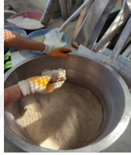
Şekil 5.14. El ile Kıvam Kontrollü
