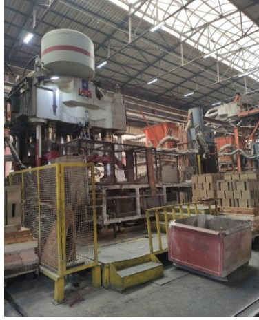
Şekil 5.9. Hidrolik Pres ( 1500 \text{ kg/cm}^2 )
